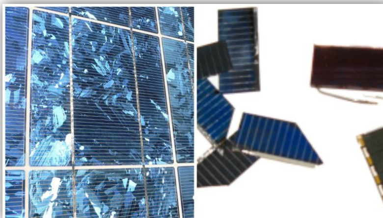
Слика 5.4 Поликристалне силицијумске ФН ћелије [7]
