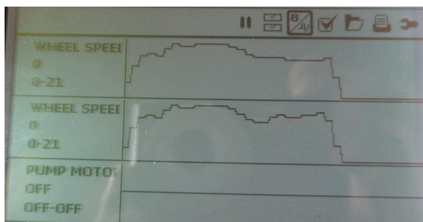
Слика 7.13 Дијаграм промене брзине кретања предњег левог и предњег десног точка
