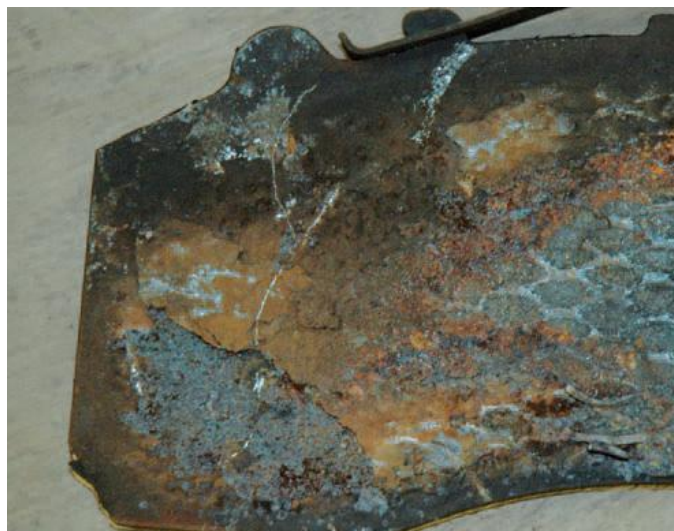
Слика 3.6 Интезивно продирање корозије
