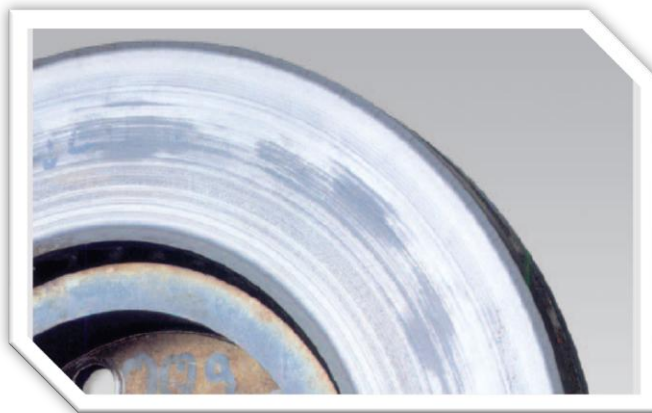
Слика 3.12 Локално прегрејани кочни диск са мрљама [6]
