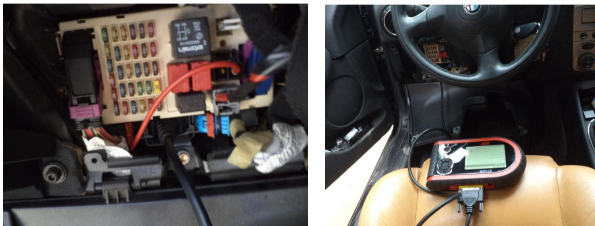
Слика 7.6 Место прикључивања дијагностичког уређаја за конкретно возило
