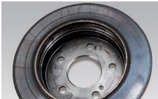
Слика 3.15 Кочни диск са мрљама насталим услед некоришћења возила
