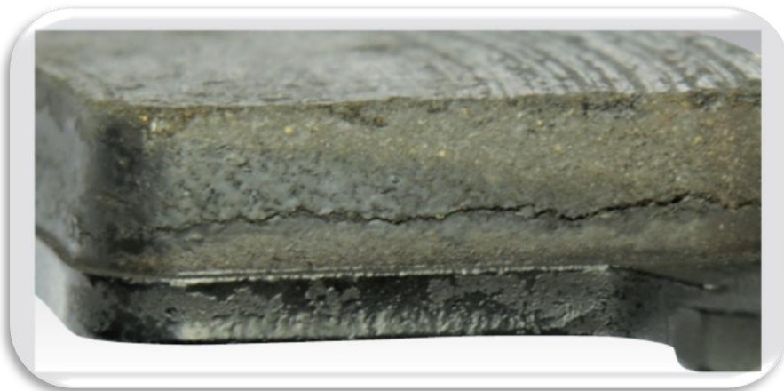
Слика 3.9 Пукотине између слојева на новој кочној облози настале у процесу производње
