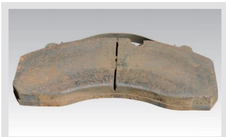
Слика 3.7 Изглед одвајања масе облоге под дејством термичког оптерећења
