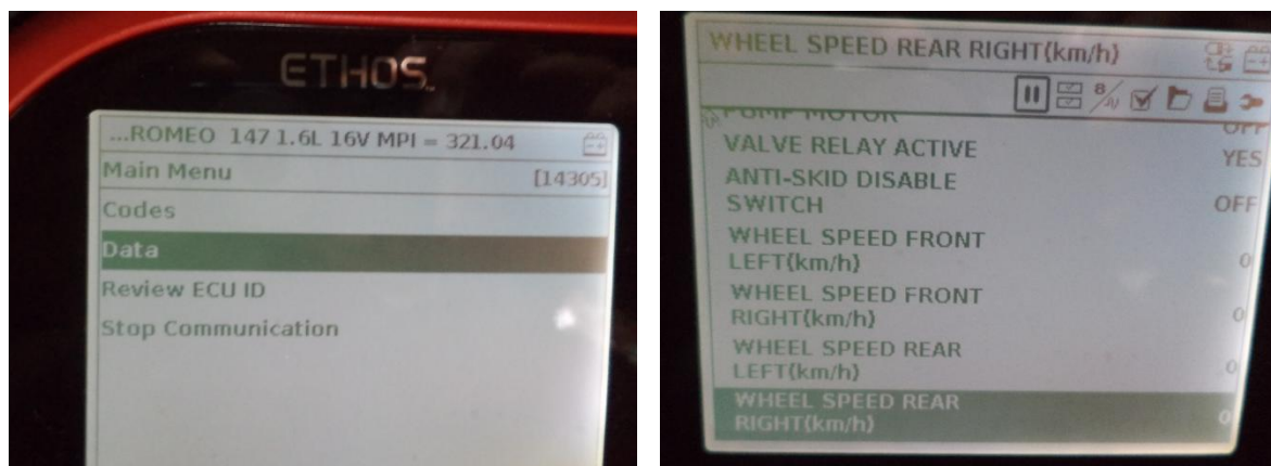
Слика 7.12 Приступ мерењу појединих компонента ABS система
