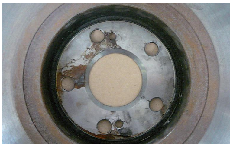
Слика 3.21 Пукотине у пределу капе кочног диска
