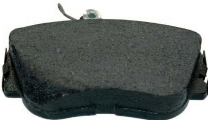
Слика 3.9 Пукотине између слојева на новој кочној облози настале у процесу производње
