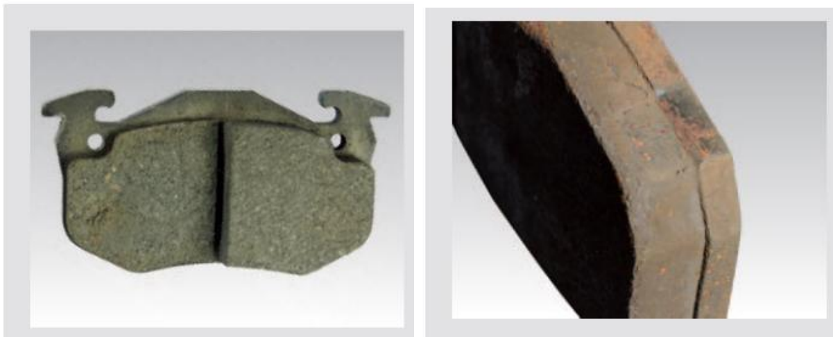
Слика 3.8 Оштећење облоге масе услед механичких утицаја [6]
