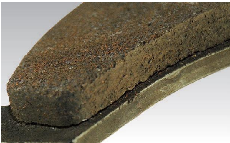
Слика 3.5 Приказ одвајања масе облоге изазвано корозијом [6]
