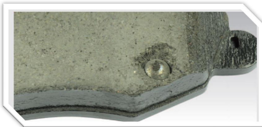
Слика 3.11 Страно тело у маси фрикционог материјала
