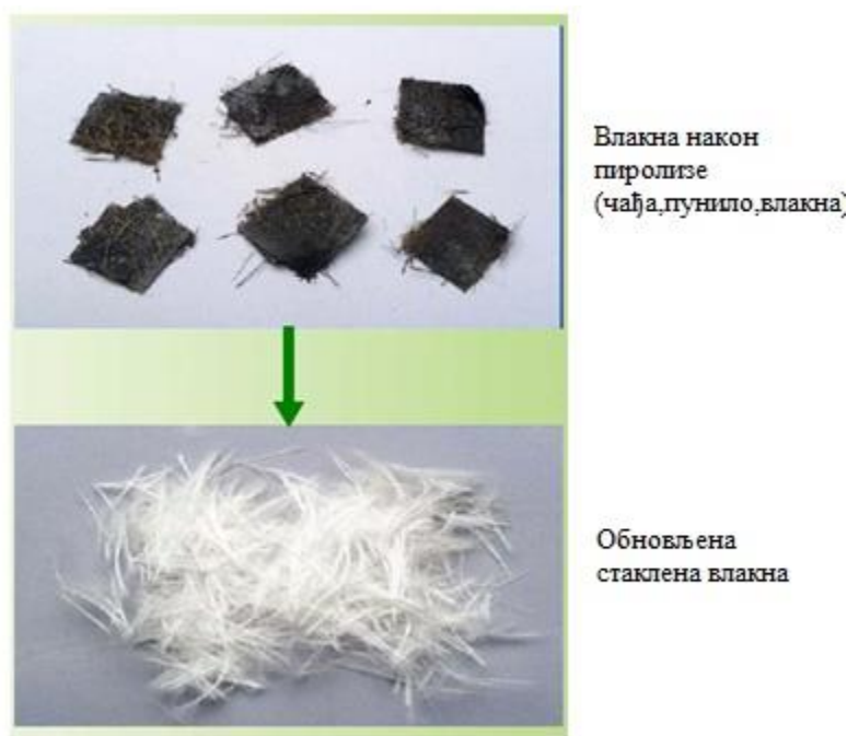
Слика 53: Изглед влакна током и после рециклаже [10]
