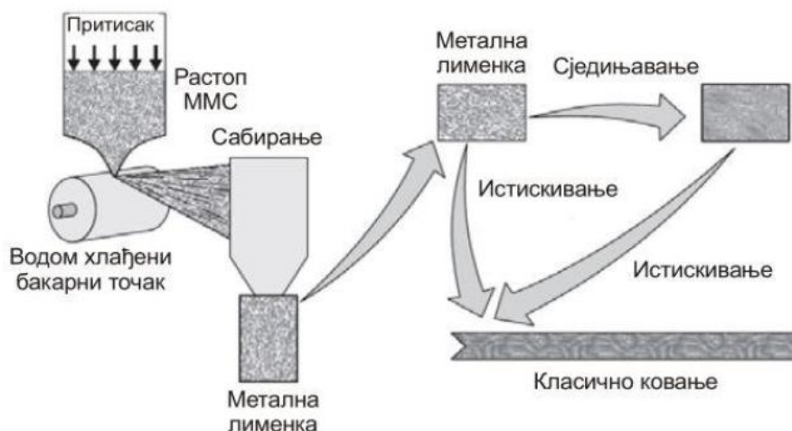
Слика 21: Поступак брзог очвршћавања [3]
