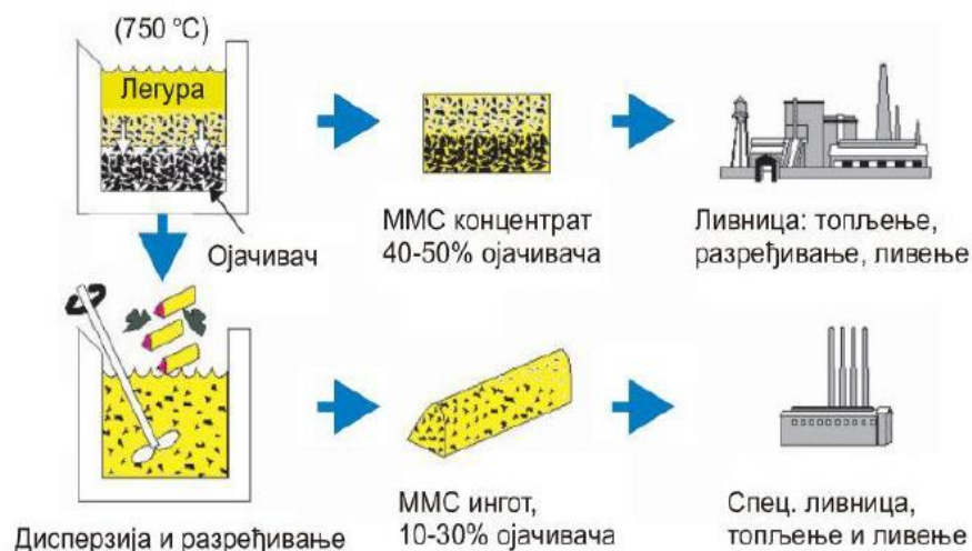
Слика 18: Шема производње ММЦ-а Primex инфилтрацијом [3]
