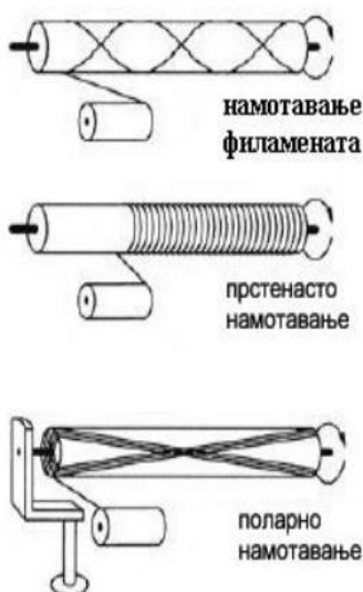
Слика 22: Приказ намотавања филамената, прстенастог и поларног намотавања [3]
