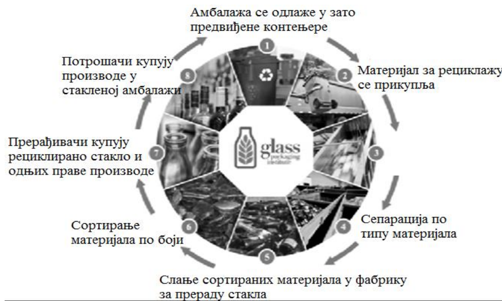
Слика 51: Процес рециклаже стаклене амбалаже [10]
