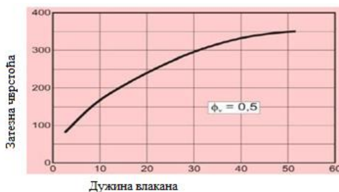
Слика 13: Однос затезне чврстоће и дужине влакана (епоксидна матрица са 50% Е стаклених влакана) [2]
