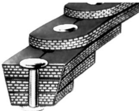
Слика 4.6 Принцип спајања сегмената у Т везу, [16]
