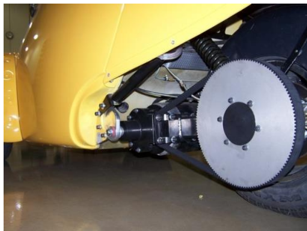
Слика 18. Пренос снаге са електро мотора на погонске точкове [8]
