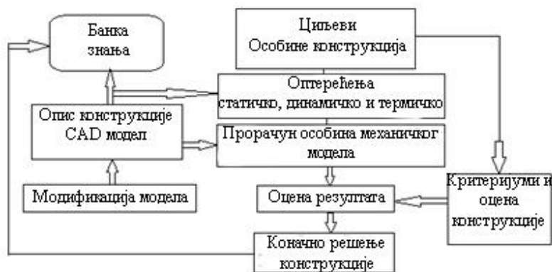
Слика 38 Концепт коришћења метода анализе у конструисању [13]
