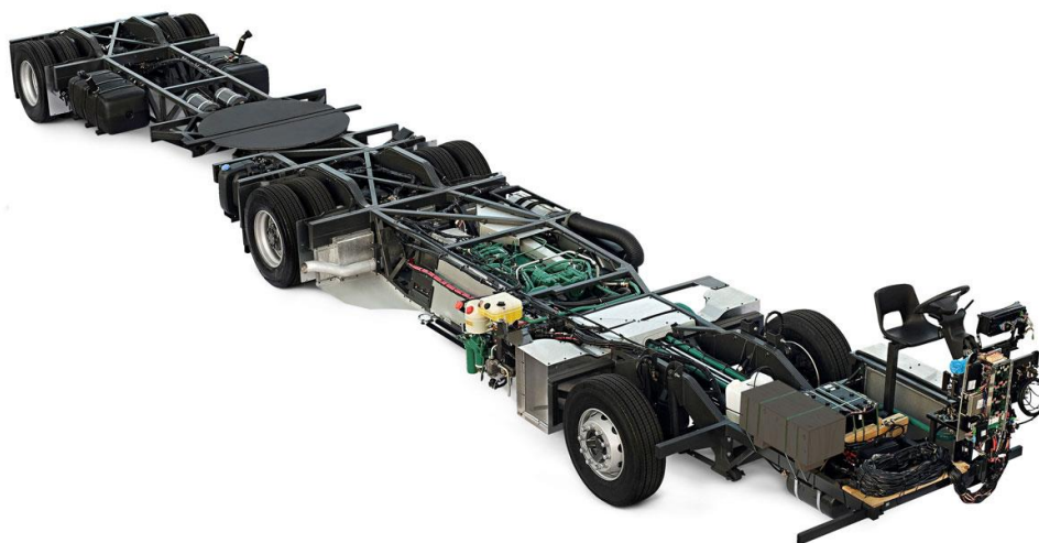
Слика 6.3. Подвожје – шасија возила категорије М3 (Volvo B340M) [27]
