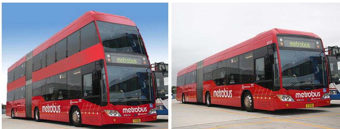
Слика 2.2. Scania N310U (шема погона 6x2) [5]
