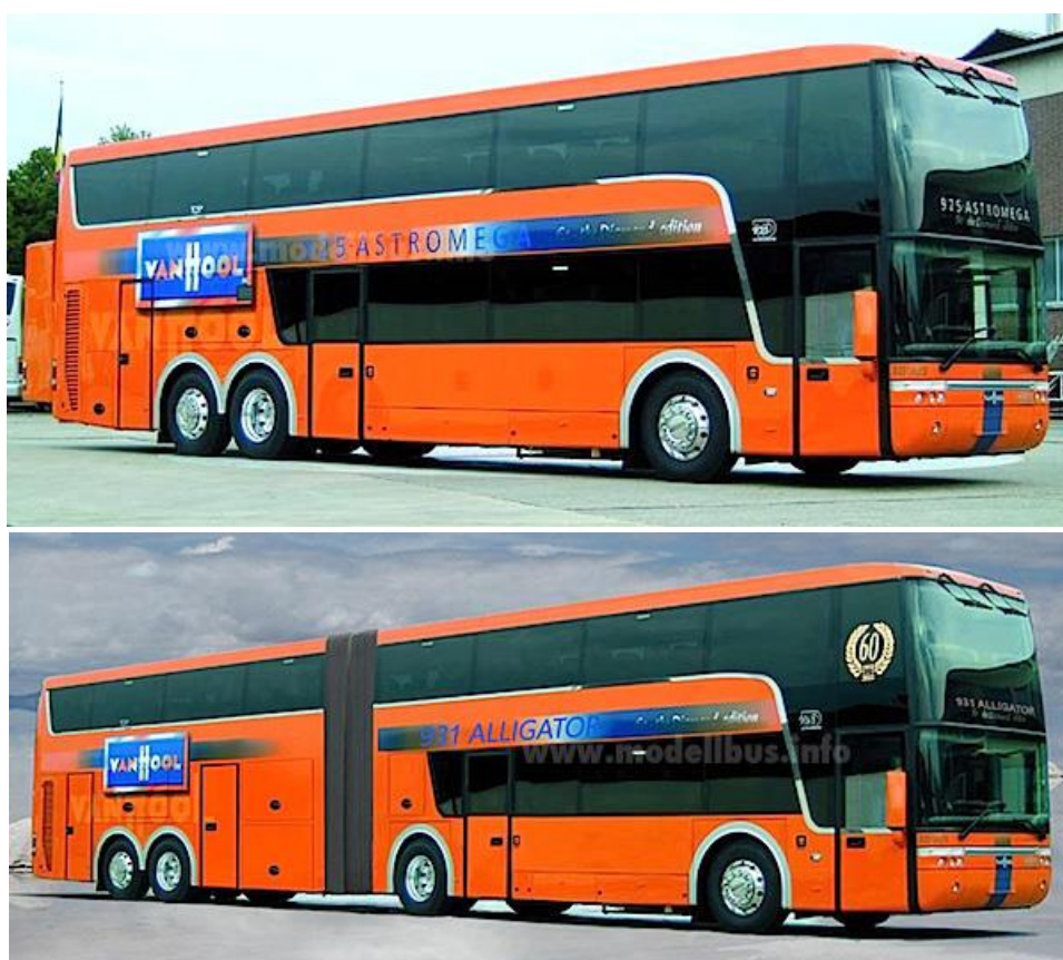
Слика 2.3. Van Hool TD925 и редизајнирани модел Van Hool TD931 „Aligator“ (шема погона 8x2)[6]
