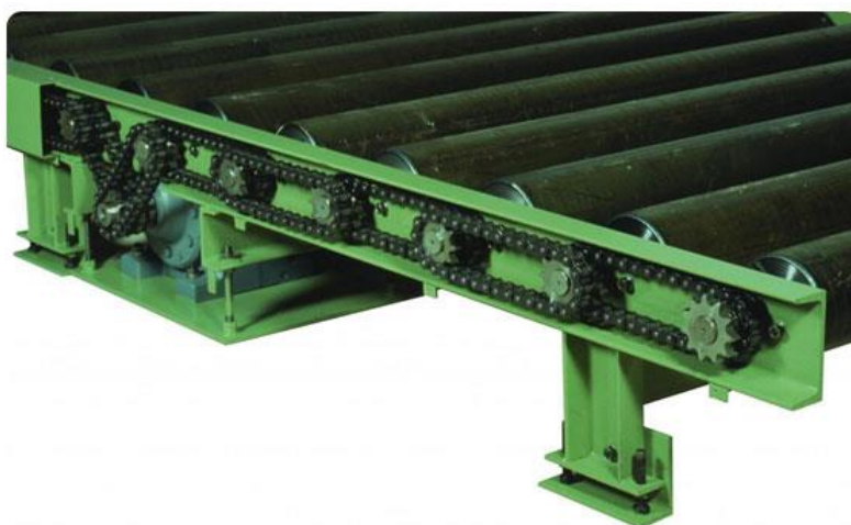
Слика 5.17. Изглед транспортера са ланчаним преносником који погони сваки пар ваљака [20]
