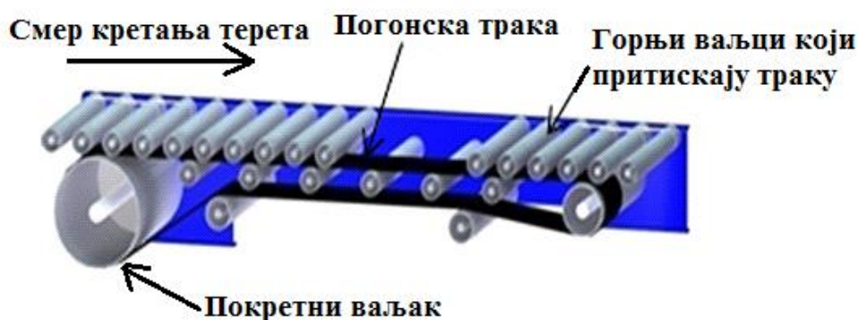
Слика 5.19. Изглед дела транспортера са траком као погон [21]
