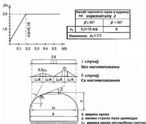
Слика 2.3.1.3: Коефицијент облика \mu_3 и оптерећења од снега на цилиндричним крововима [1][2]
