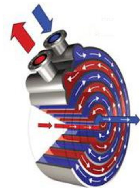
Слика 15: Принципска шема спиралног плочастог размењивача топлоте
