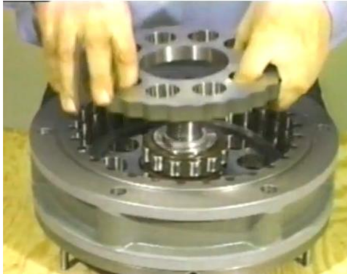
Слика 1.10 Детаљи из процеса монтаже циклоредуктора (СУМИТОМО) [2]
