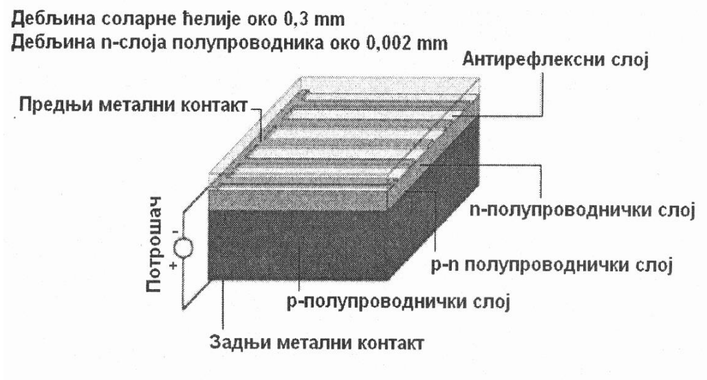
Слика 8. Принцип функционисања ФН ћелије
