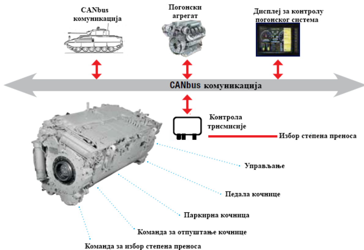
Сл. 2.12. Контрола рада погонског система тешких гусеничних возила преко CANbus комуникације [11]
