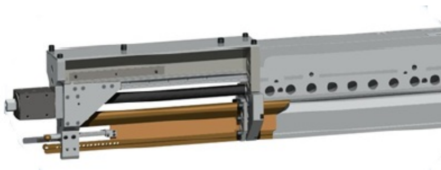
Слика 3.16. Елементи дизне за подешавање ширине течења [13]
