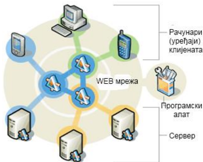
Слика 3.2. Клијент/сервер архитектура информационог система [12]
