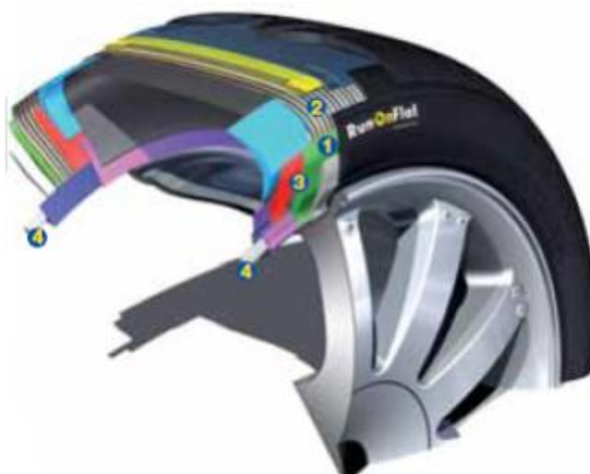
Слика 45 – Најновија генерација RunOnFlat [7]
