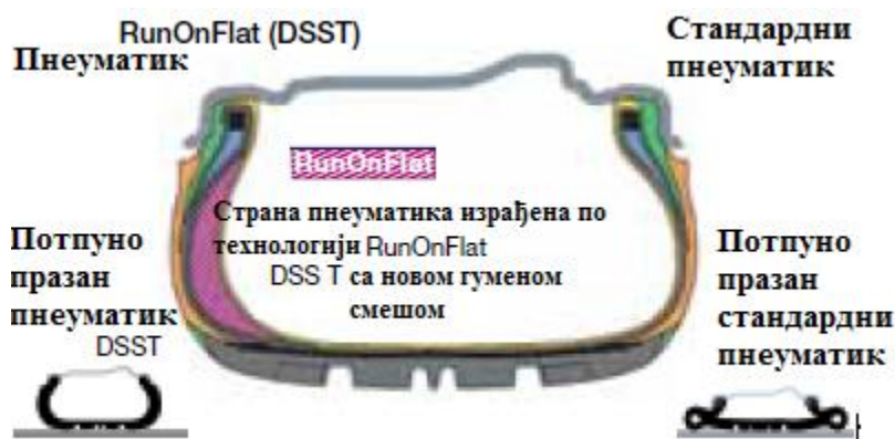
Слика 41 – Поређење стандардног и DssT пнеуматика [6]
