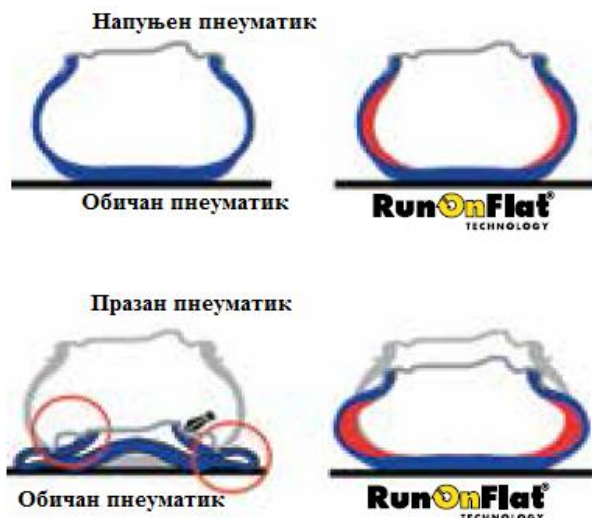
Слика 47 - Упоредни приказ обичног и RunOnFlat пнеуматика [7]
