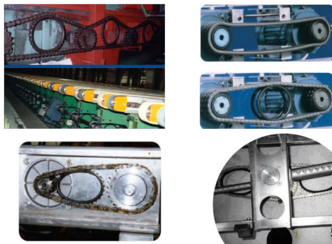
Слика 26. Еластични прстен за затезање ланца [4]
