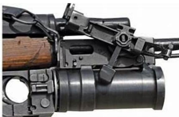
Слика 13. БГП-40 монтиран на М70 [13];
