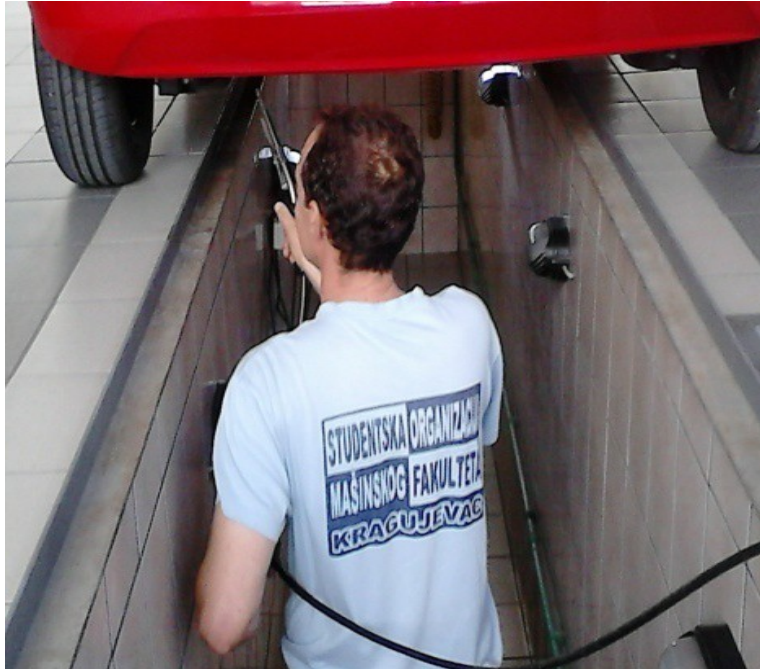
Слика 5.14. - Постављање сонде у издувну цев огледног возила
