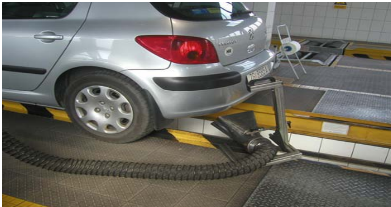
Слика 5.5. -- Постављање цеви за одвођење издувних гасова са издувне цеви возила[13]
