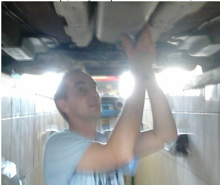
Слика 5.13. - Проверавање причвршћености и исправност издувног лонца и цеви, као и катализатора из канала
