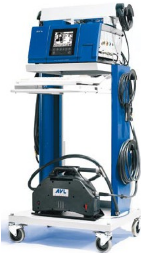
Слика 4.6 – Уређај AVL DiCOM 4000 [10]
