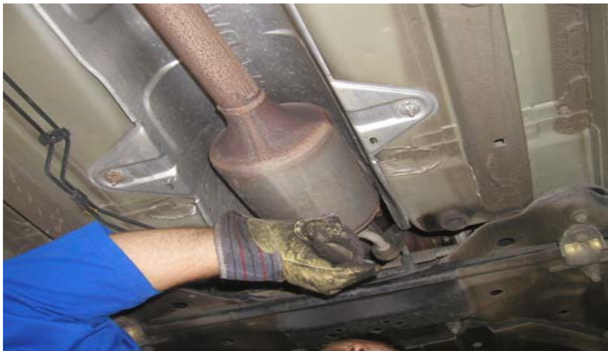
Слика 5.3. – Провера преграда унутар издувног лонца [13]
