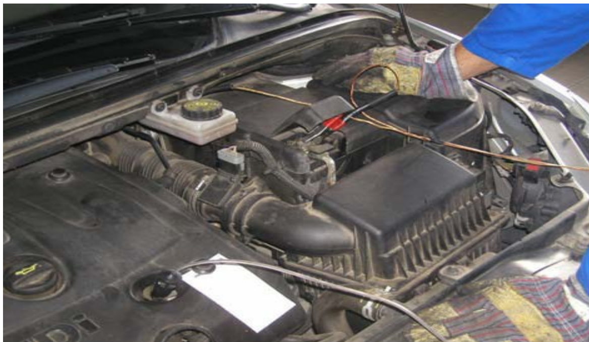
Слика 5.7. – Положај индукционих клешта по високонапонском каблу [14]
