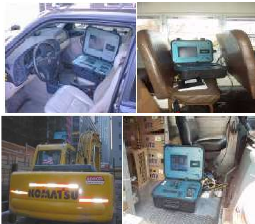
Слика 4.3 – Примери постављања ОЕМ – 2100 система на моторна возила [8]
