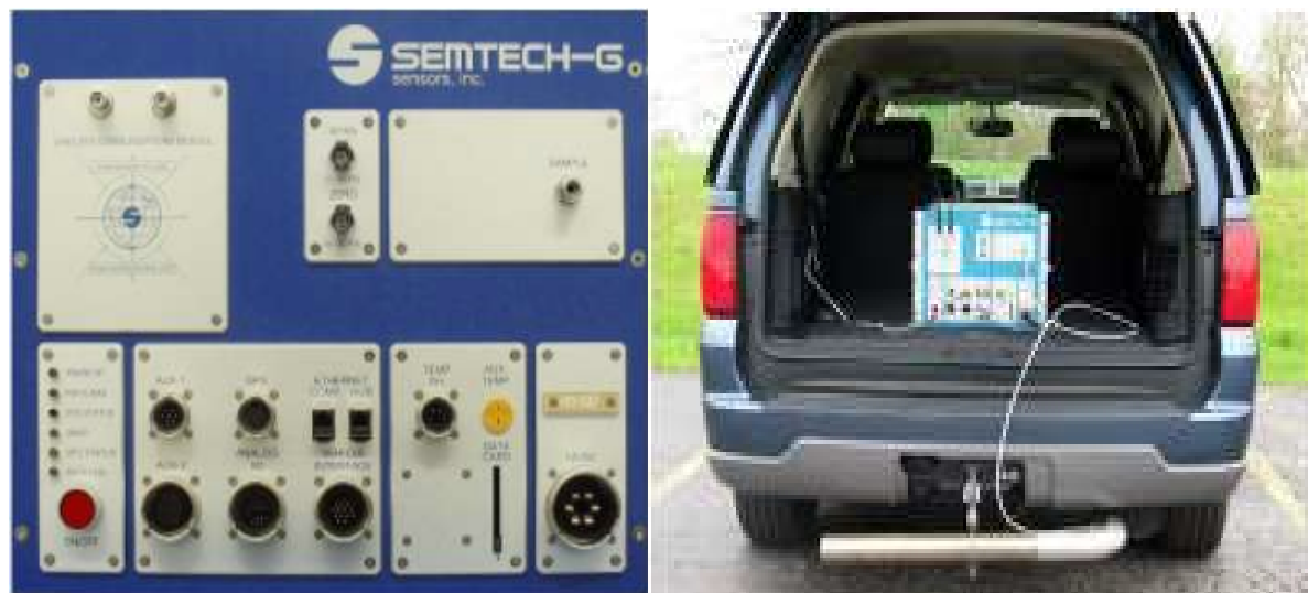
Слика 4.4 – Анализатор издувних гасова бензинских мотора „ SEMTECH-G ” [8]
