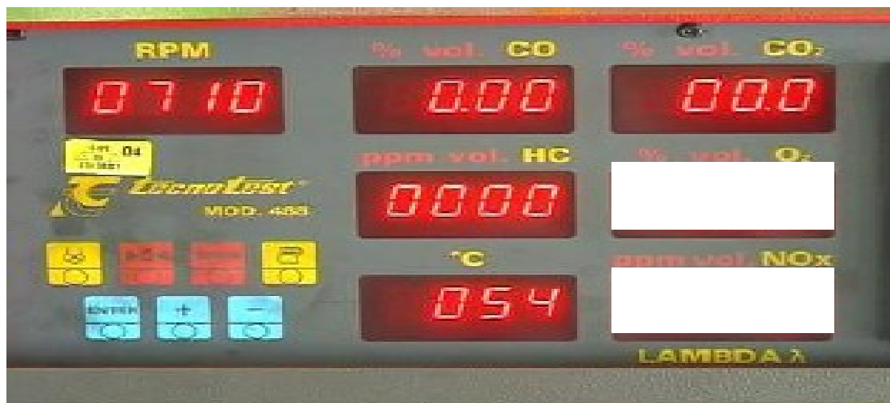
Слика 6.6 – Анализатор са измереним подацима издувних гасова на Škodi Citigo
