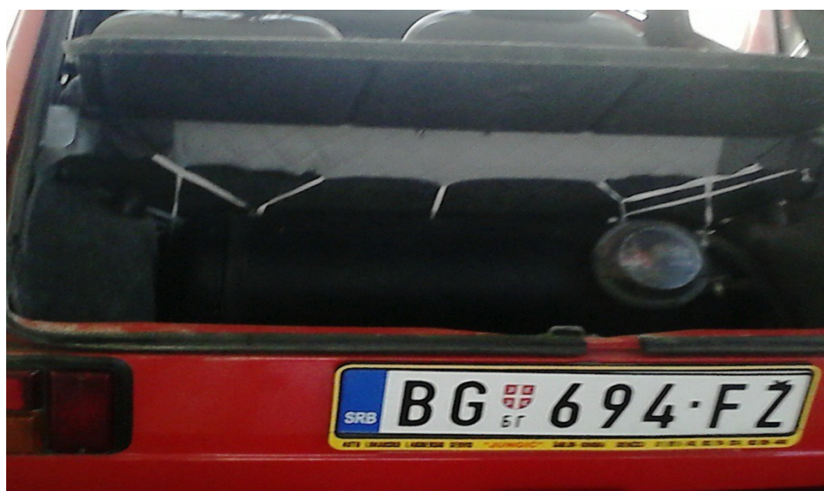
Слика 6.1. – Огледно возило Застава 101 са „Lovato” уграђеним ТНГ уређајем
