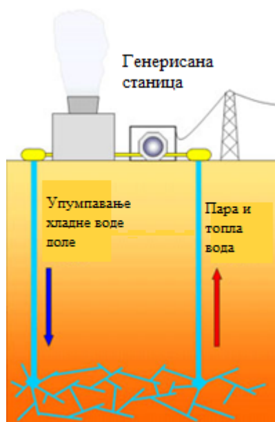
Слика 8. Приказ методологије претварања геотермалне у електричну енергију
