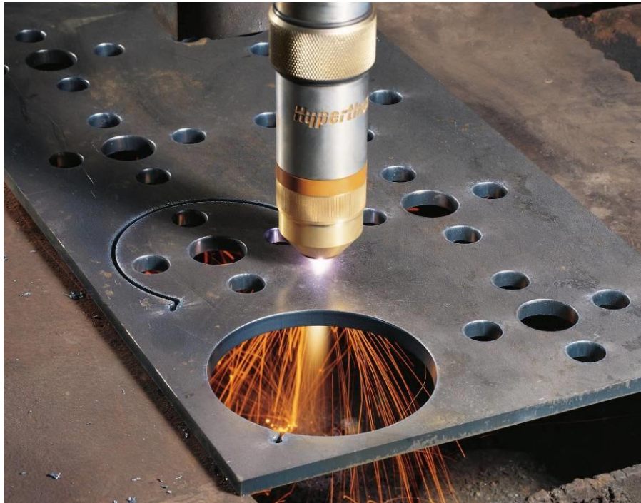
Слика 2.3 Сечење плазмом [4]
