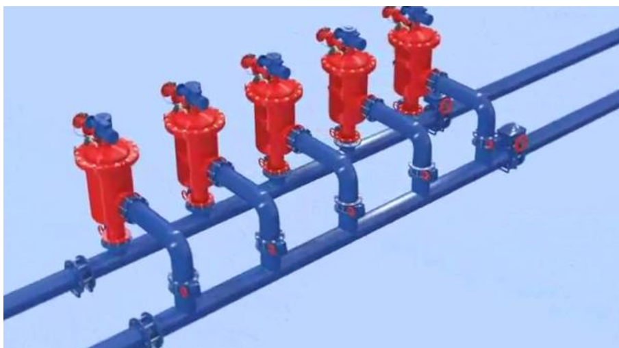
Слика 11.9. Начин монтирања пет паралелно постављених филтра
