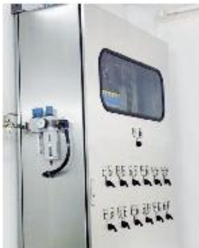
Слика 12.3. Контролни орман са ручно контролисаним панелом 45
