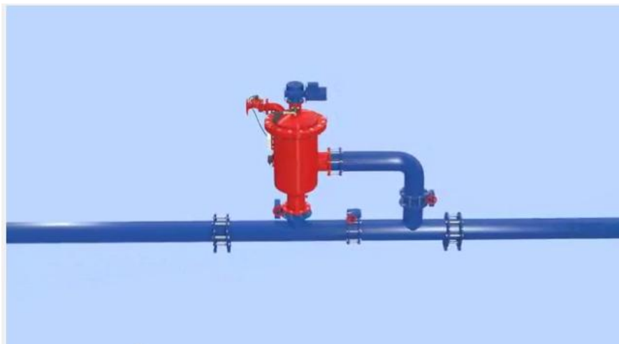
Слика 11.8. Начин монтирања филтра на једном од магистралних цевовода
