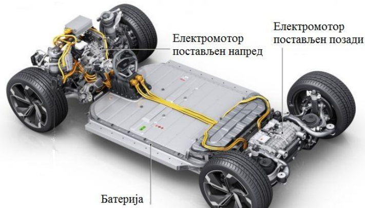
Слика 23. Приказ концепције електричног аутомобила са два електромотора [31]
