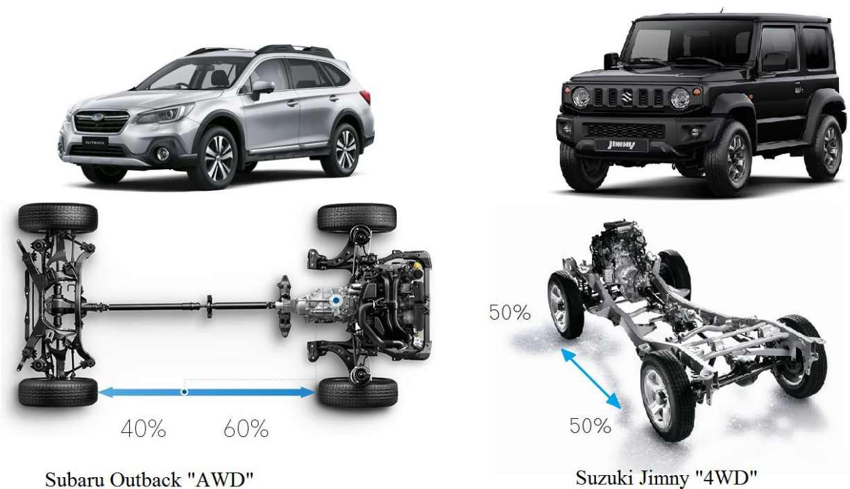
Слика 20. Приказ типа возила са АВД и 4ВД погоном [30]
