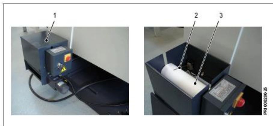
Слика 17 – Интегрисани филтер са ваљком магацина: 1 - Ваљак магацина са поклопцем, 2 - Сензор ваљка и 3 - Ваљак папира.
