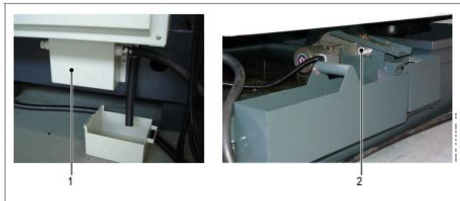
Слика 16 – Резервоар за уље: 1 - Конструкција резервоара, 2 - Сита у резервоарима [6].
