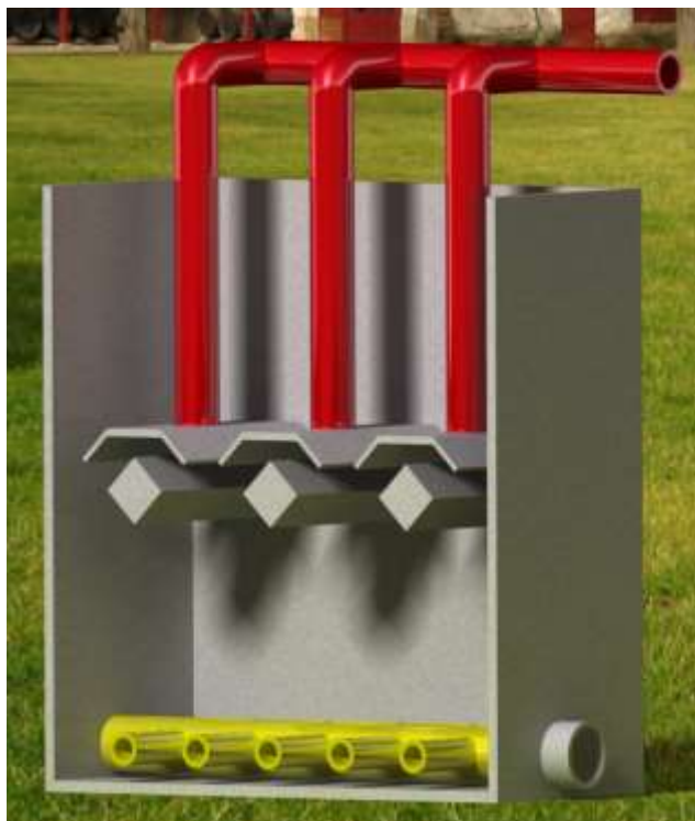
Слика 16. Унутрашњост UASB реактора
