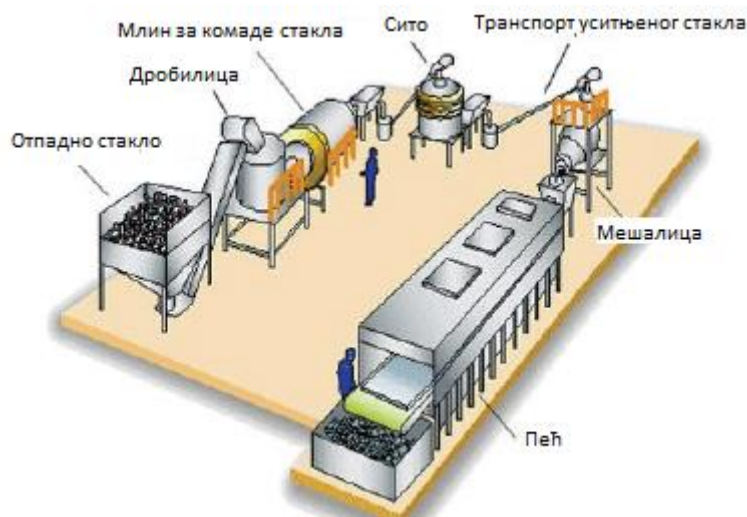
Слика 21. Постројење за рециклажу стакла [49]
