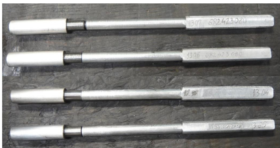
Слика 7.22. Контролници цеви
