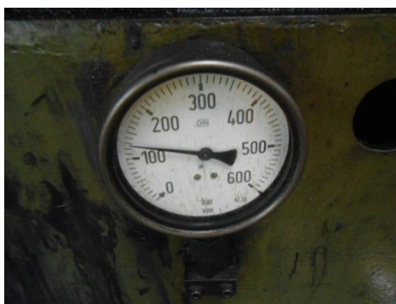
Слика 7.16. Барометар (притисак од 120 bar-а из кога произилази сила стезања цеви стезачима (В) и (С))
