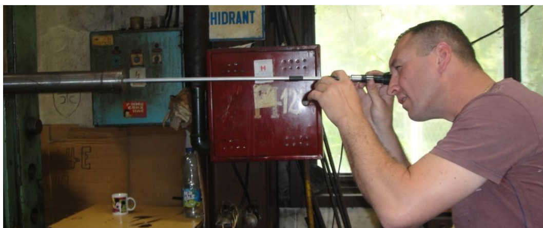
Слика 7.27. Очна контрола цеви
