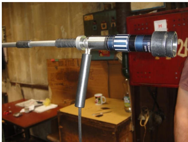
Слика 7.26. Уређај за очну контролу цеви ( KARLHEINZ-HINZE MESSTECHNIK-OPTRONIK )
