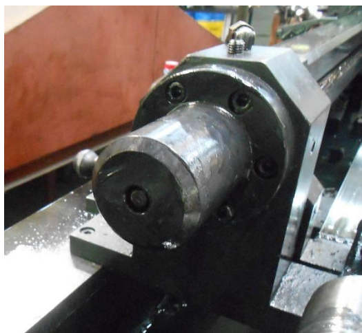
Слика 7.12. Поступак постављања потискивача
