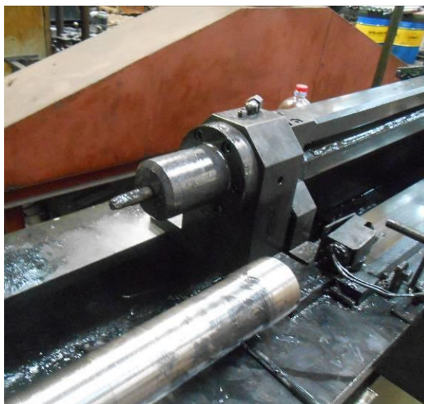
Слика 7.11. Постављање трна у отвор ослонца (А)
