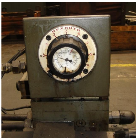
Слика 7.19. Контрола силе протискивања преко притиска (60 bar-a)
