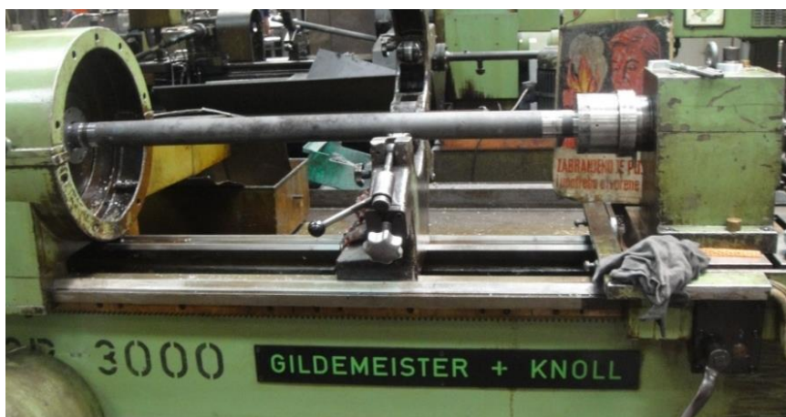
Слика 7.5. Припремак цеви кал. 12,7x108 mm на машини за дубоко бушење
