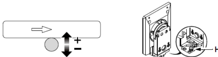
Слика 60. Дубина скидања траке регулисна завртњем
