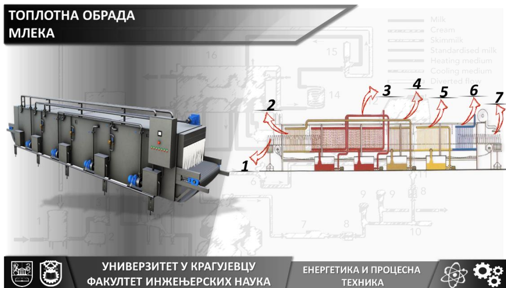
Слика 30. Тунелски пастеризатор (1-улаз млека (стаклена, пластична амбалажа), 2-секција предгревања, 3-секција пастеризације, 4-секција потхлађивања 1, 5-секција потхлађивања 2, 6-секција хлађења, 7-излаз пастеризованог млека)
