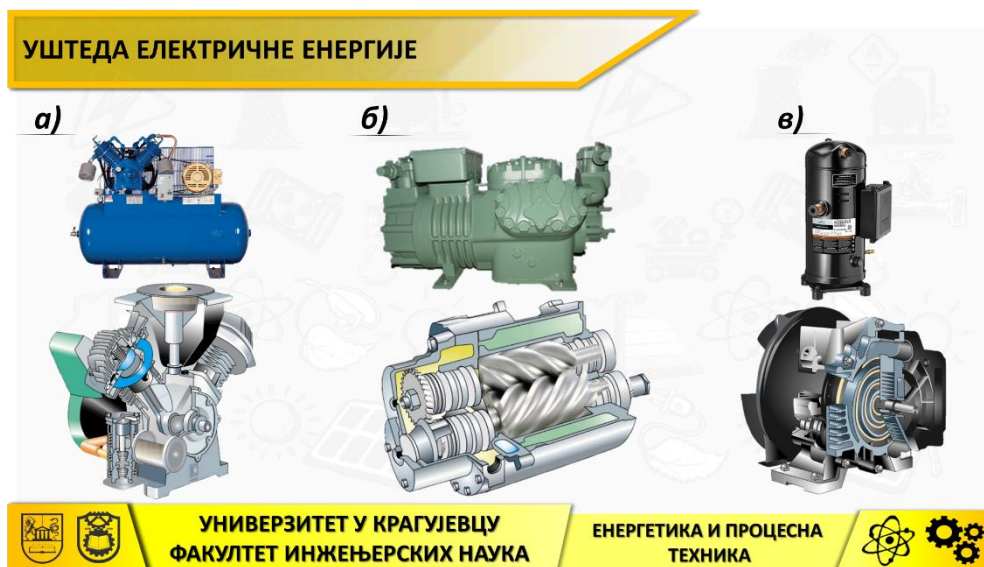
Слика 84. Најчешће примењивани тип компресора у расхладним системима а) клипни, б) завојни, в) спирални
