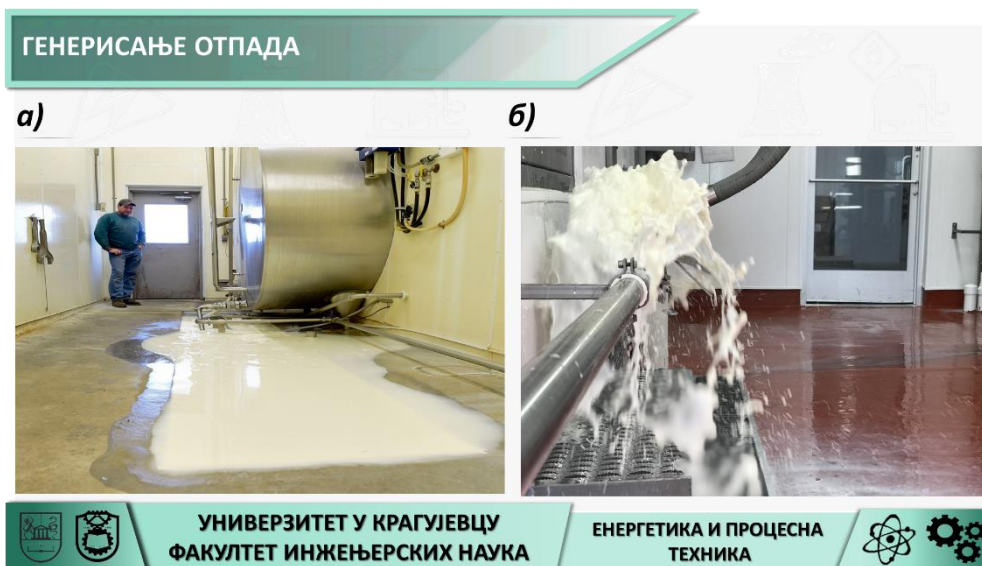
Слика 101. Губитак услед неадекватног руковања, током примарне фазе обраде сировог млека а) изливање млека услед неисправности пријемног резервоара (вентил у квару), б) изливање млека током процеса истакања, услед непричвршћеног млековода
