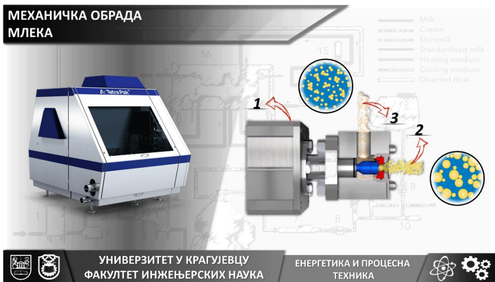
Слика 23. Хомогенизатор (1-глава хомогенизатора, 2-улаз нехомогенизованог млека, 3-излаз хомогенизованог млека)
