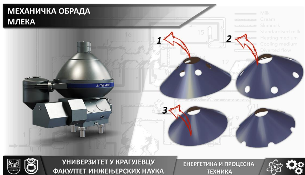
Слика 17. Центрифугални сепаратор (1-диск за сепарацију млека, 2-диск за бактофугацију млека, 3-дискови за кларификацију млека)
