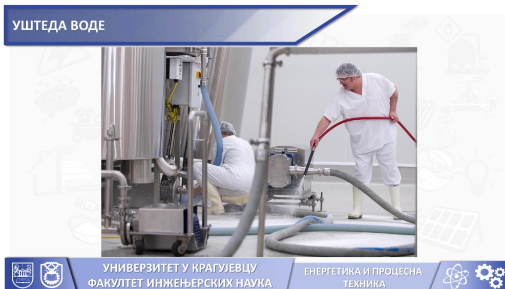
Слика 96. Чишћење подне подлоге у погону прехрамбене индустрије употребом високопритисних млазница [116]
