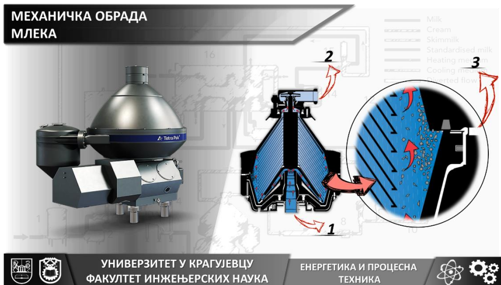
Слика 18. Шематски приказ кларификације млека (1-улаз млека, 2-излаз пречишћеног млека, 3-отвор за одвод механичких нечистоћа)
