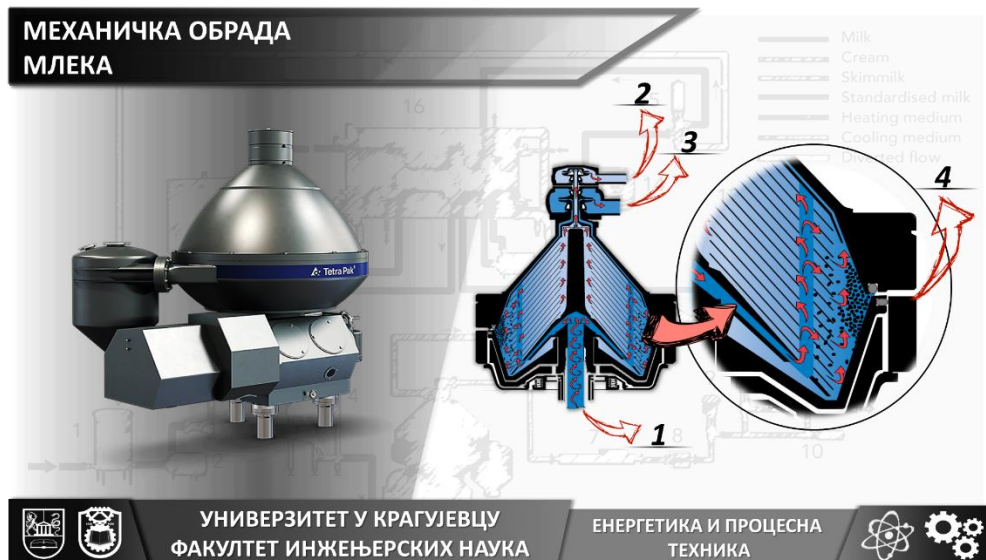
Слика 19. Шематски приказ двофазног бактофугатора (1-улаз млека, 2-излаз пречишћеног млека, 3-излаз бактофугата (без бактерија), 4-отвор за одвод механичких нечистоћа)
