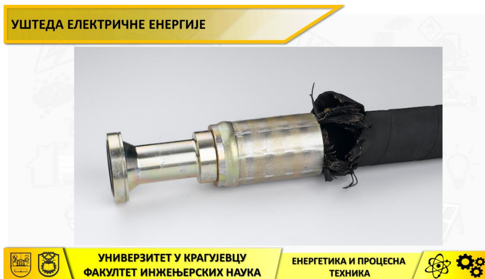
Слика 90. Оштећење настало услед превеликог притиска компримованог ваздуха, на цреву (крајњи корисник) [112]
