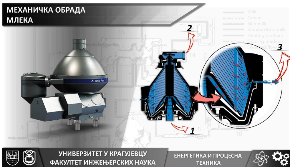
Слика 20. Шематски приказ једнофазног бактофугатора (1-улаз млека, 2-излаз пречишћеног млека (без бактерија), 3-отвор за одвод бактерија и механичких нечистоћа)
