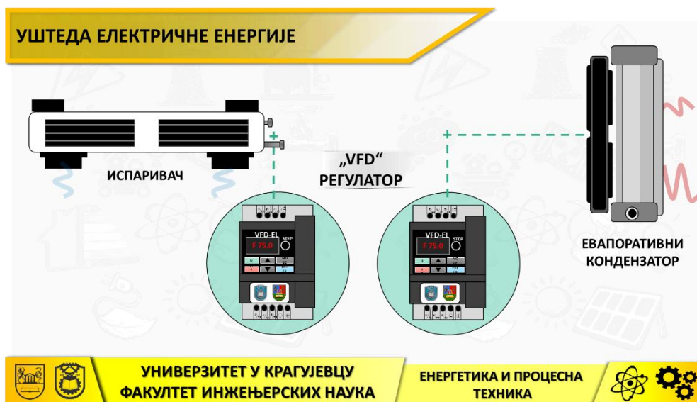
Слика 83. Употреба фреквентних регулатора (кондензатори и испаривачи)
