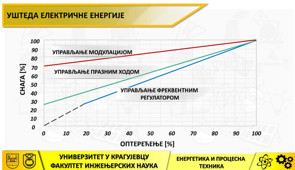
Слика 89. Поређење потрошње енергије једностепених ротационих завојних компресора са убризгавањем течности за подмазивање, за различите управљачке системе
