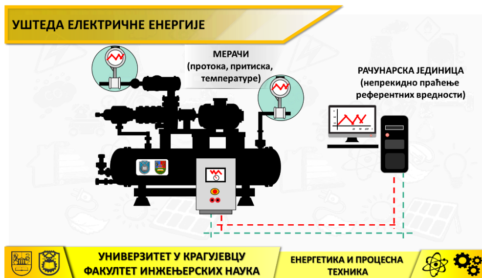
Слика 77. Континуално праћење притиска на улазу и излазу из компресора
