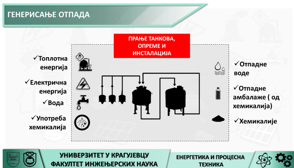
Слика 102. Шема поступка чишћења и утицај на животну средину
