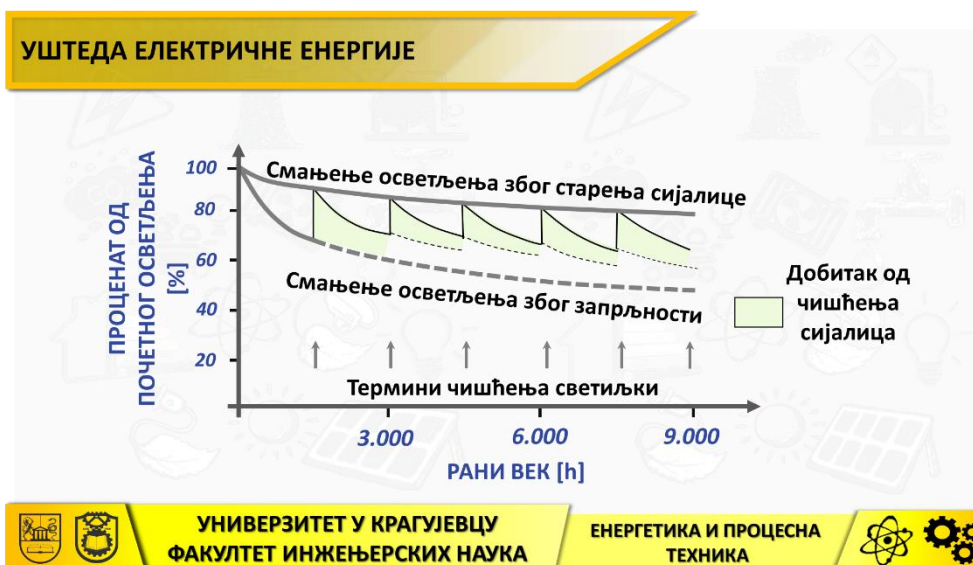
Слика 73. Ефекат одржавања и чишћења сијалица на ниво светлосног излаза
