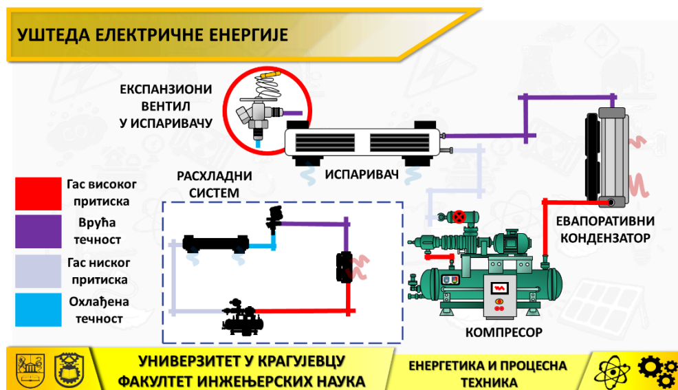
Слика 75. Принципијелна шема рада расхладног система (са механичком компресијом паре)
