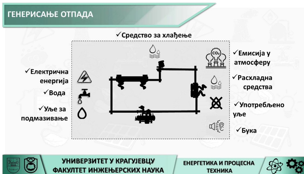
Слика 105. Шема расхладног система, употребљене сировина и врсте насталог отпада
