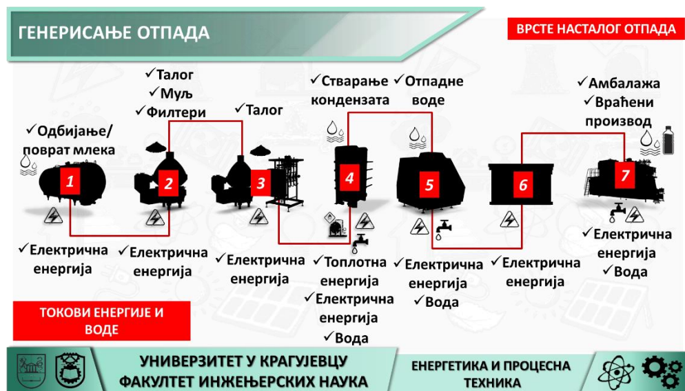
Слика 100. Токови енергије (топловне и електричне) и воде, и врсте отпада насталог током производње конзумног млека (1-пријем и складиштење млека, 2-филтрација и чишћење, 3-обирање и стандардизација, 4-топловна обрада, 5-хомогенизација, 6-складиштење на хладном, 7-паковање)
