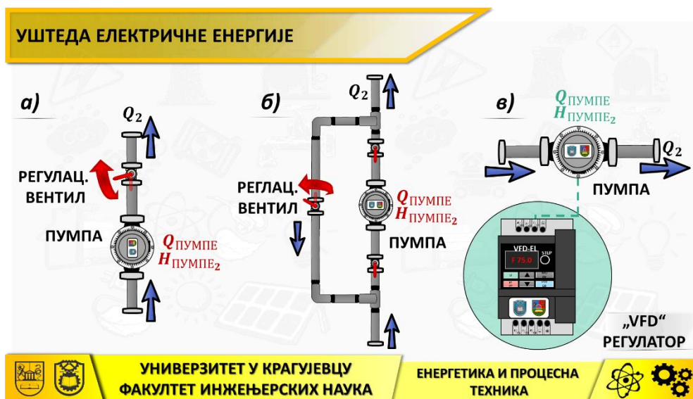
Слика 66. Неки од типова регулације код пумпи а) управљање пригушивањем, б) управљање „bypass“ оптичним водом, в) управљање „VFD“ регулатором
