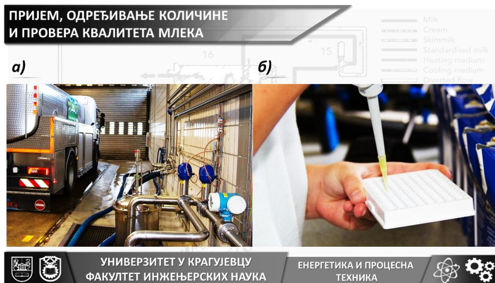
Слика 15. Одељење за пријем сировог млека а) пријем и одређивање количине пристиглог млека, б) узимање узорка за потребе одређивања физичких, хемијских и хигијенских карактеристика млека
