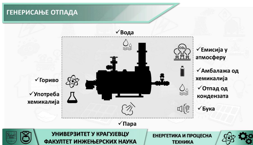
Слика 104. Шема настанка паре, употребљених сировина и врсте насталог отпада
