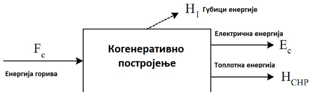
Слика 1. Блок дијаграм когенеративног постројења [4]
