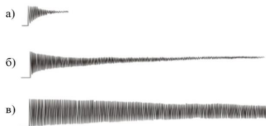
Слика 4.18 Пригушивање осцилација у одливцима: а) сивог лива, б) угљеничних челика и в) легура алуминијума
