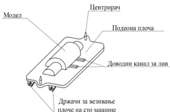
Слика 4.10 Једнострана моделна плоча
