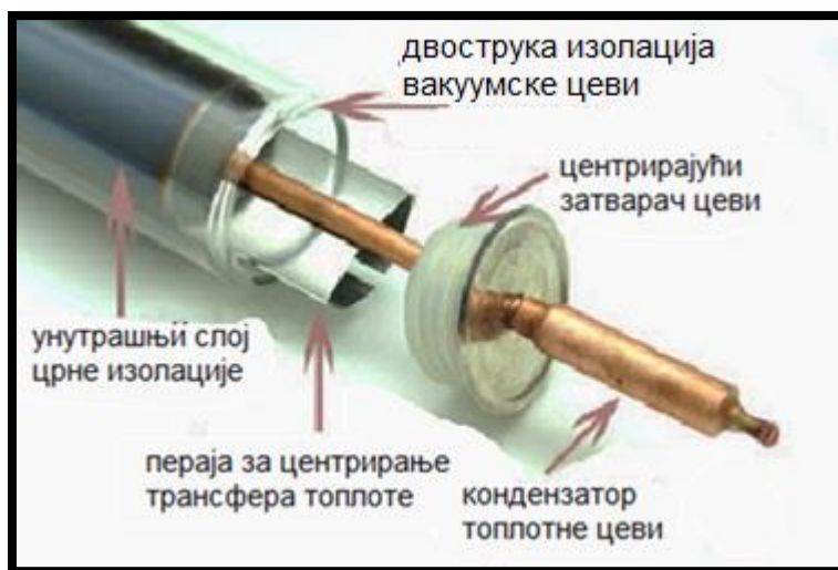
Слика 5.2 Двослојно изолована вакуумска цев
