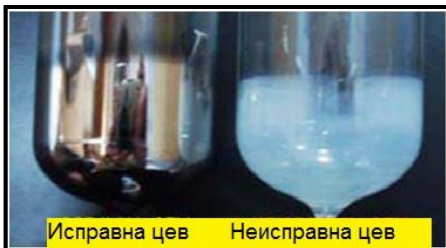
Слика 5.3 Разлика исправне и неисправне вакуумске цеви
