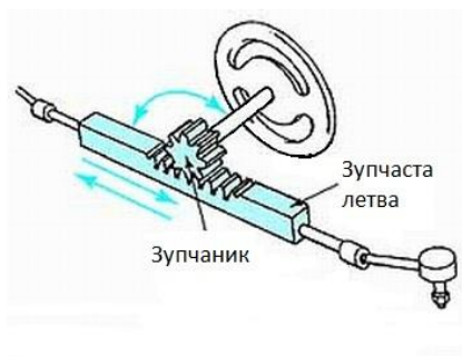
Слика 5.30 - Илустрација функционисања управљачког система
