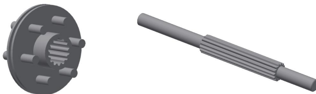
Слика 5.18 - Озубљење на носачу конуса и вратилу
