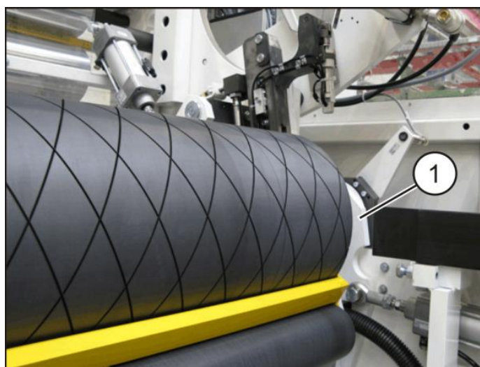
Слика 5.5. (1) Систем за замену ролни са прихватном виљушком и окретним ваљком
