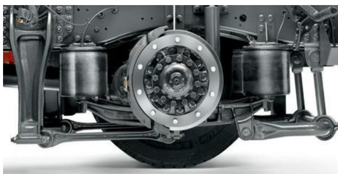
Слика 65 – Iveco камион са електронски контролисаним ваздушним ослањањем [13]
