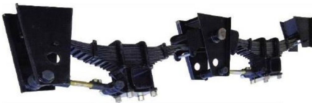
Слика 44 – Балансирајући систем за ослањање [11]
