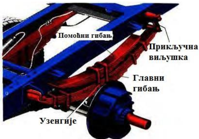
Слика 43 – Положај двоструких лиснатих гибњева теретног возила [1]
