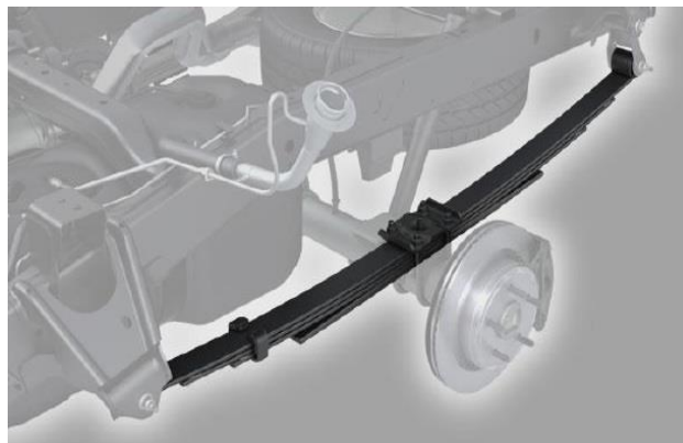
Слика 43 – Положај двоструких лиснатих гибњева теретног возила [1]
