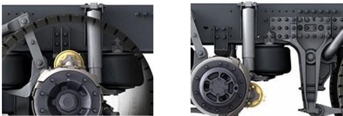
Слика 63 – Ваздушно ослањање камиона произвођача Volvo [12]
