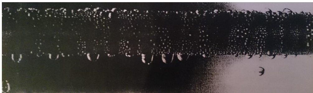
Слика 5.4 Капљичаста кондензација на цилиндричној површини [11]
