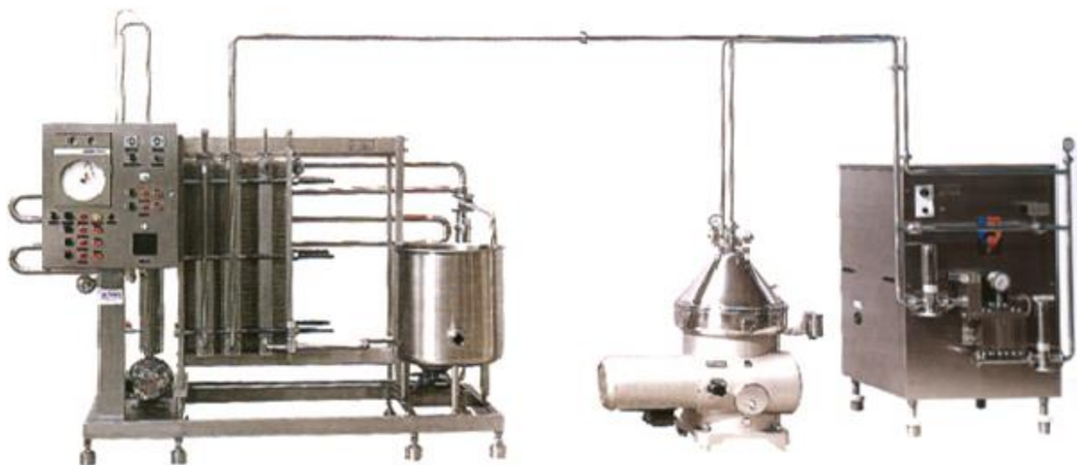
Слика 2.1. Линија за пастеризацију (балансни котлић, пастерапарат, сепаратор, хомогенизатор и контролна табла) [20]
