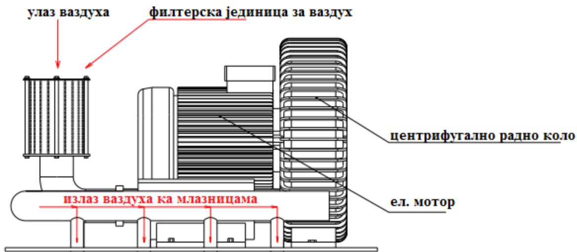
Слика 6.11 Приказ улаза и излаза ваздуха из система ка млазницама
