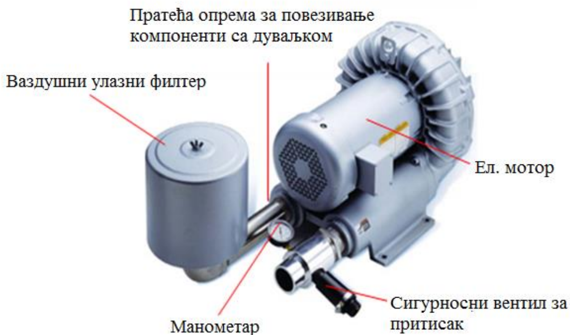
Слика 6.15 Изглед склопа дувалке 50760-R5
