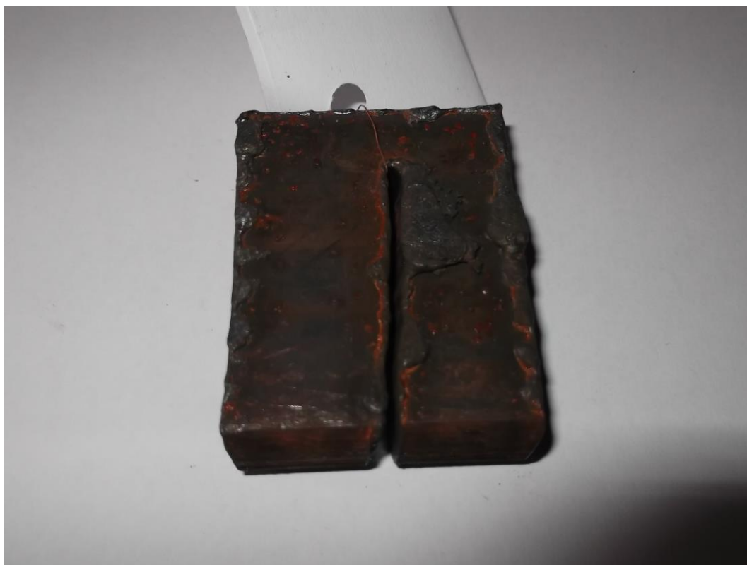
Слика 118 – Узорак – 21 диза I нивоа похабаности - 635 mm/min
