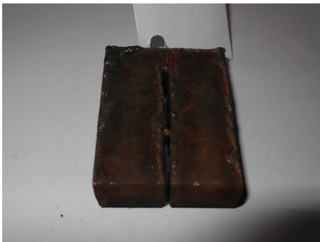
Слика 122 – Узорак – 25 димензија III нивоа похабаности - 530 mm/min
