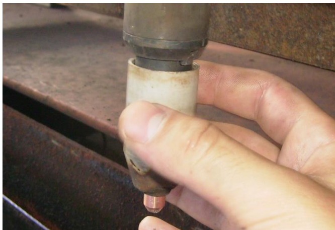
Слика 56– Завијање керамичке заштитне капе са адекватном дизном
