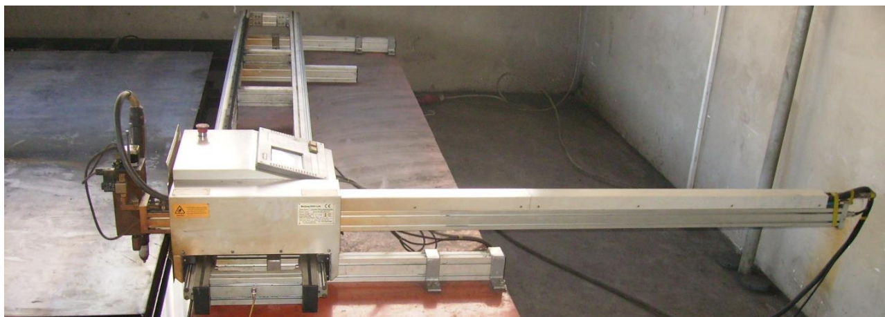
Слика 22 – Покретна управљачка јединица и штап Y осе
