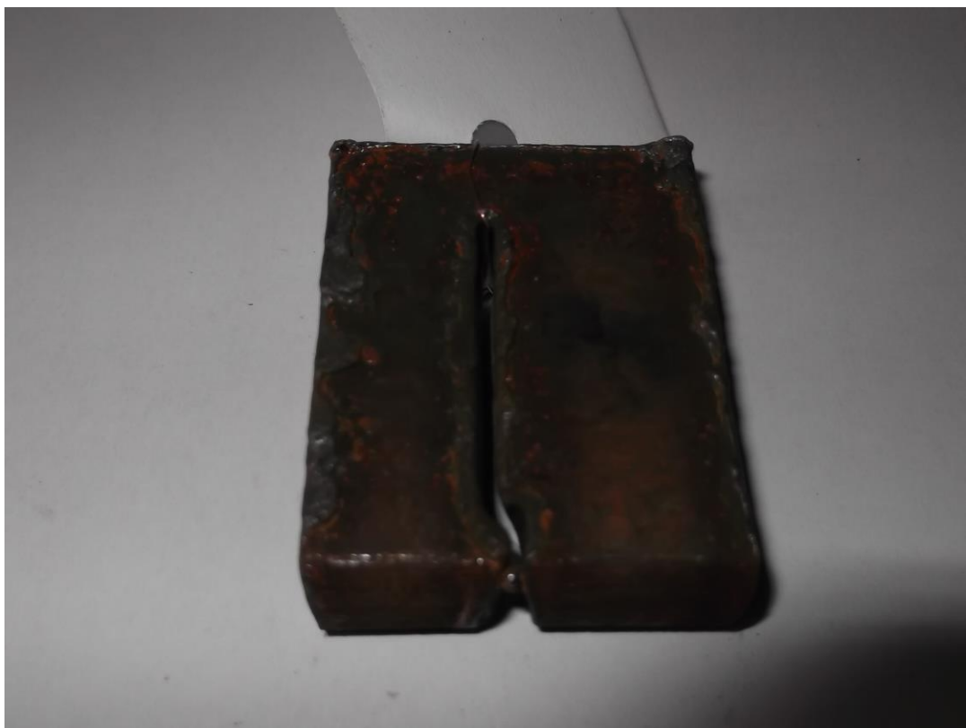
Слика 121 – Узорак – 24 дизна II нивоа похабаности - 635 mm/min
