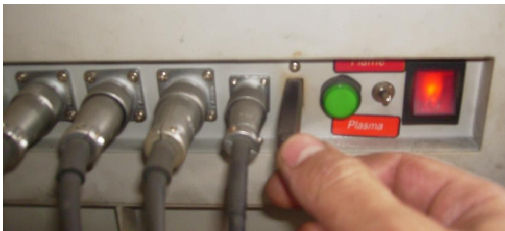
Слика 47– Прикључивање УСБ меморије
