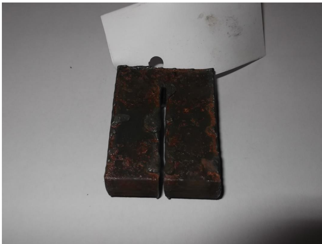
Слика 107 – Узорак 13 – 5,28 mm – 530 mm/min
