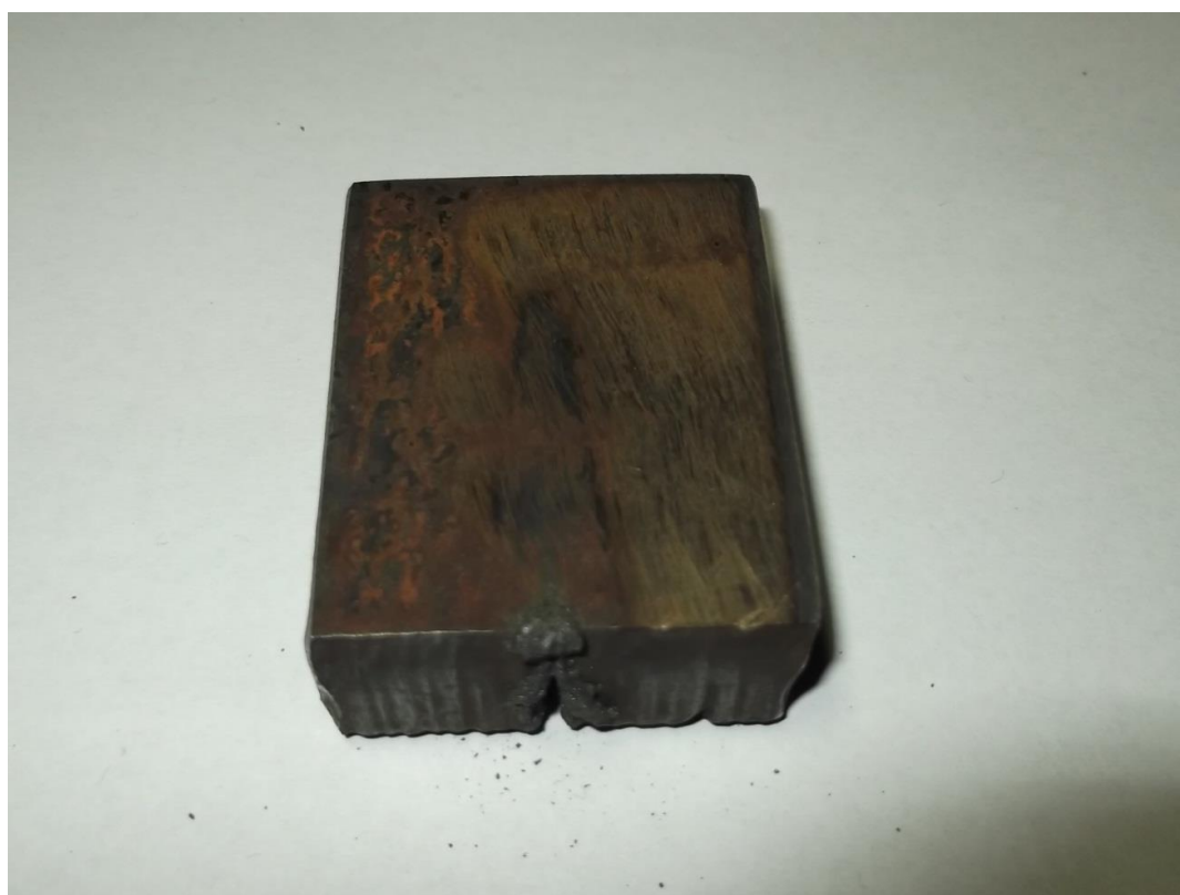
Слика 95 – Узорак 3 – 60A – 635 mm/min
