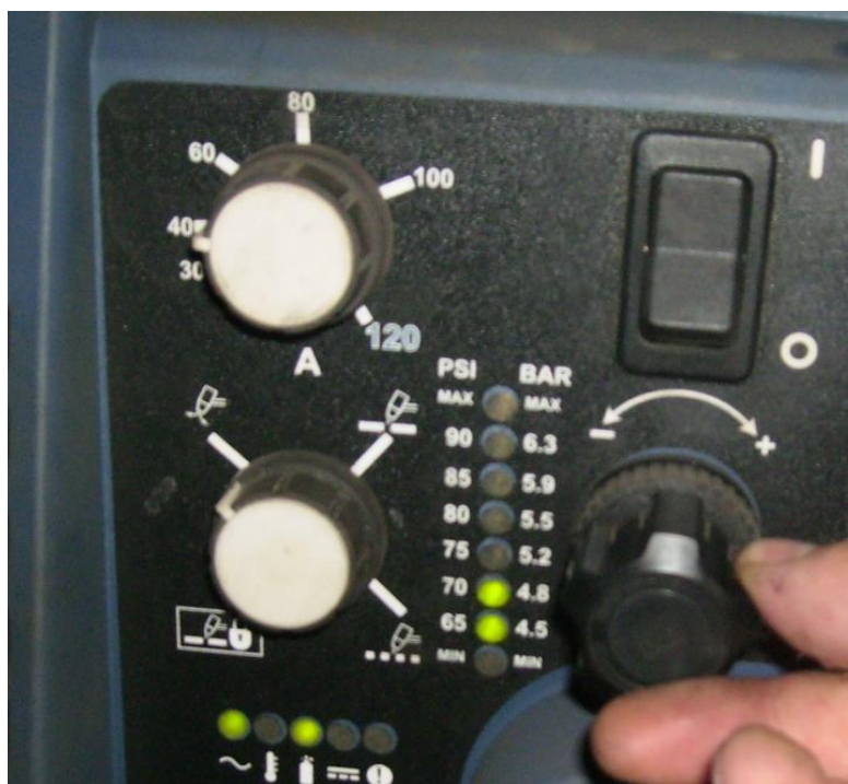
Слика 50– Подешавање притиска ваздуха
