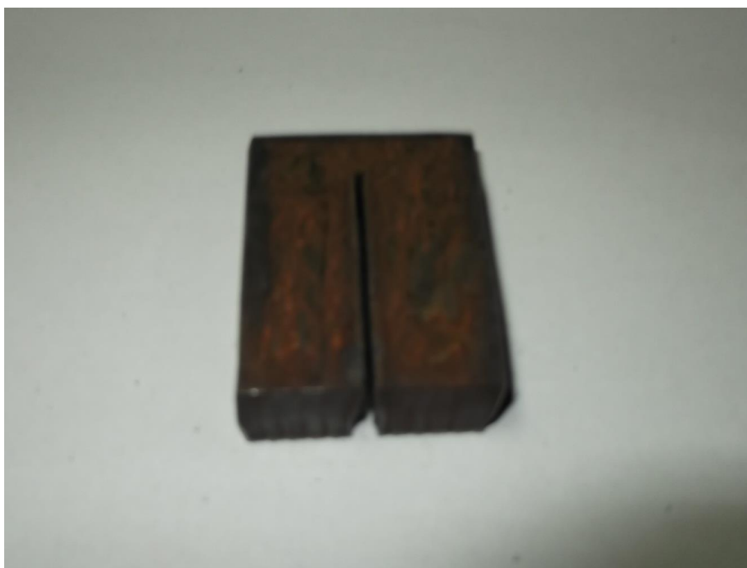
Слика 102 - Узорак 10 – 120A – 1320 mm/min
