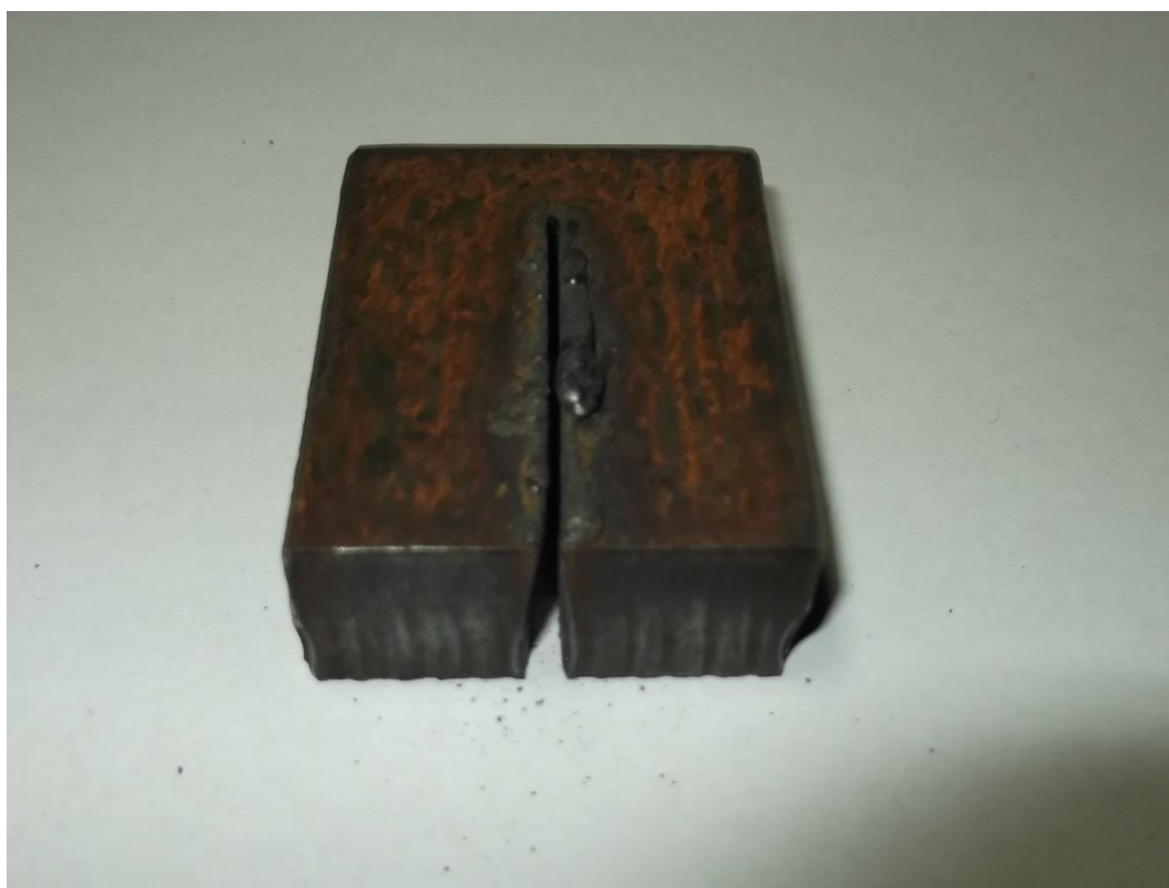
Слика 98 - Узорак 6 – 80A – 730 mm/min
