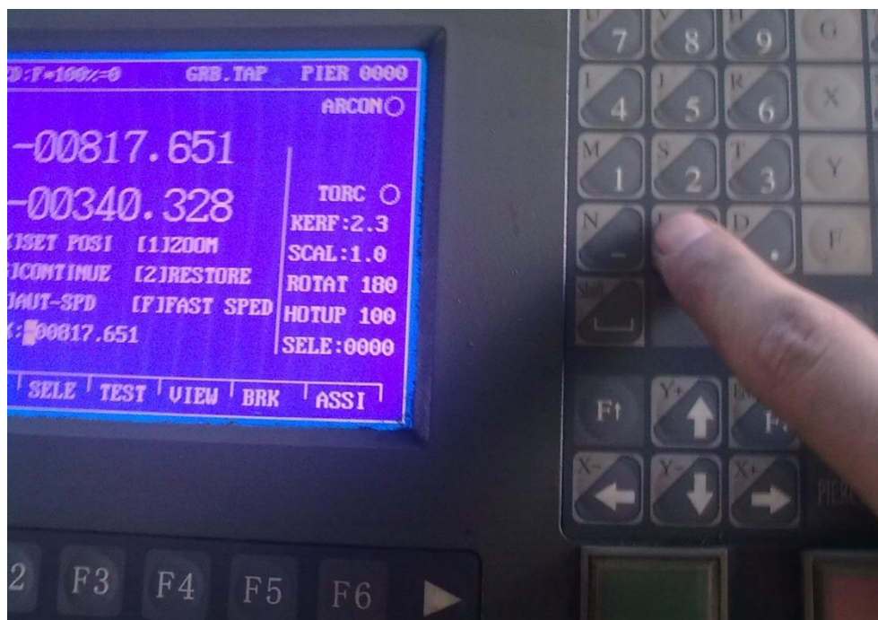
Слика 73—Дефинисање вредности X координате
