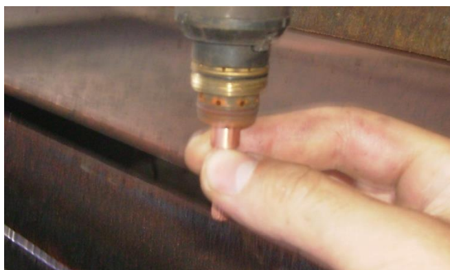
Слика 55– Замена електроде
