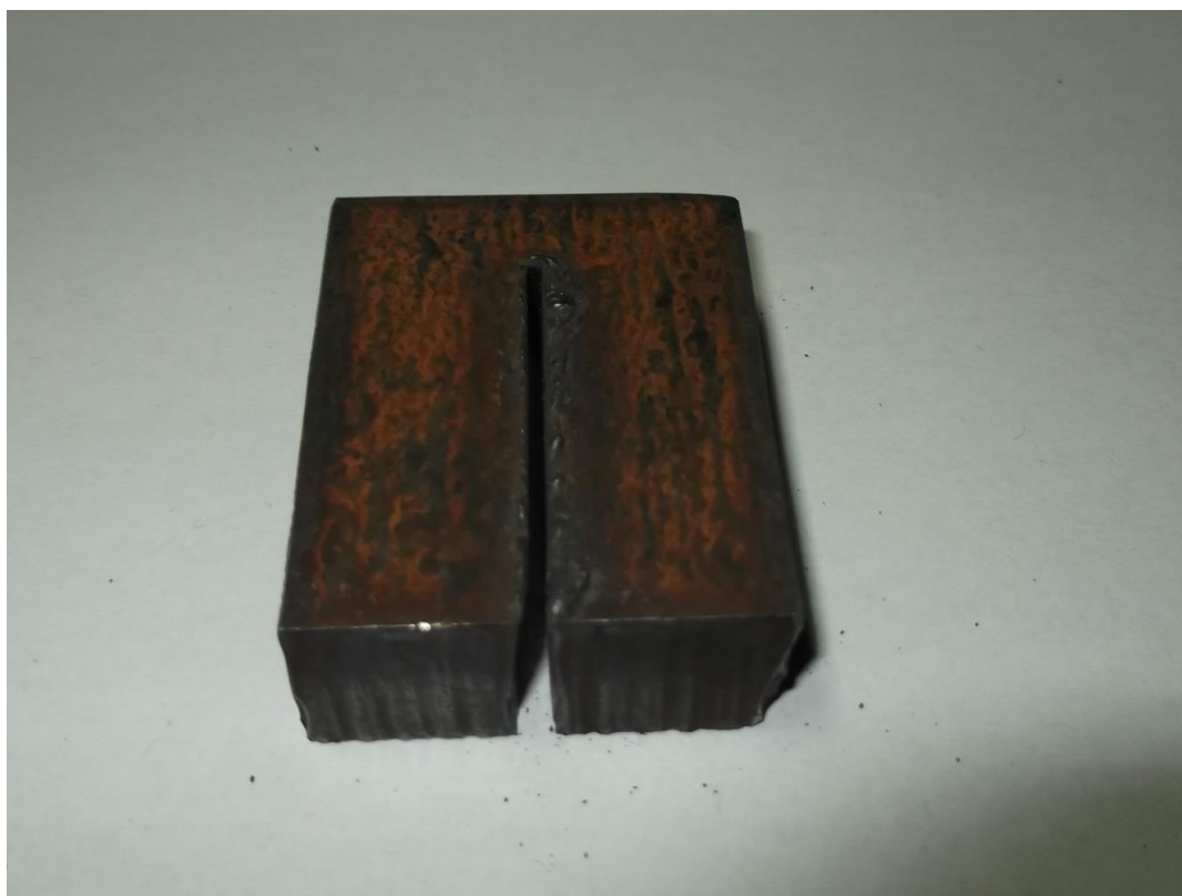
Слика 97 - Узорак 5 – 80A – 490 mm/min
