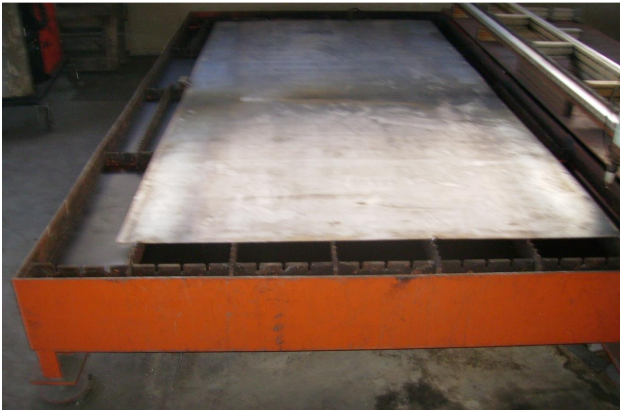
Слика 20 – Постоље припремка (лим 1,5m x 3m)
