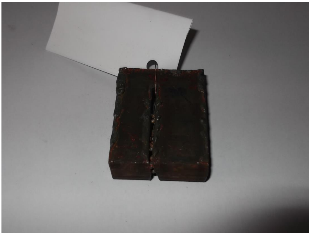
Слика 119 – Узорак – 22 диза II нивоа похабаности - 530 mm/min
