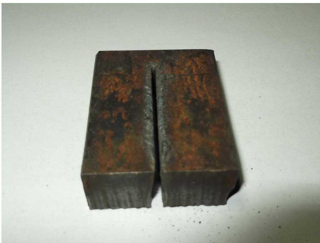
Слика 99 - Узорак 7 – 100A – 870 mm/min
