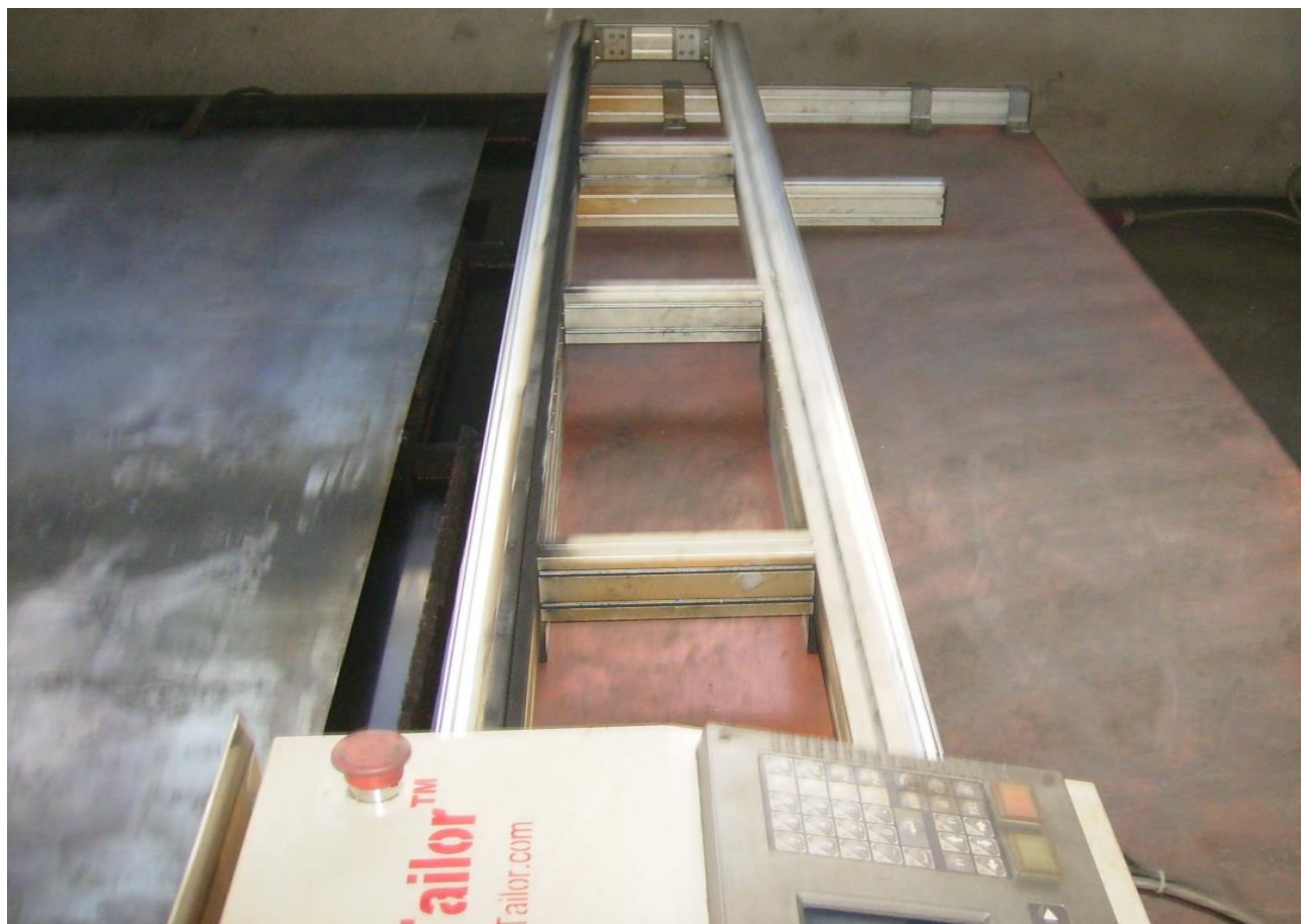
Слика 21 – Шине X осе са постољем
