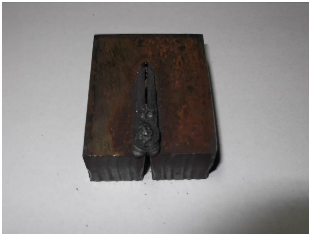
Слика 93 – Узорак 1 – 60A – 530 mm/min
