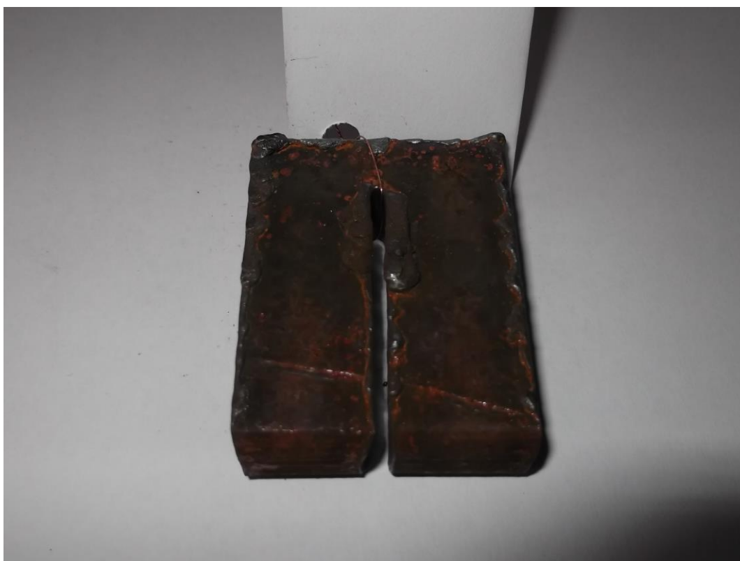
Слика 123 – Узорак – 26 диза III нивоа похабаности - 425 mm/min
