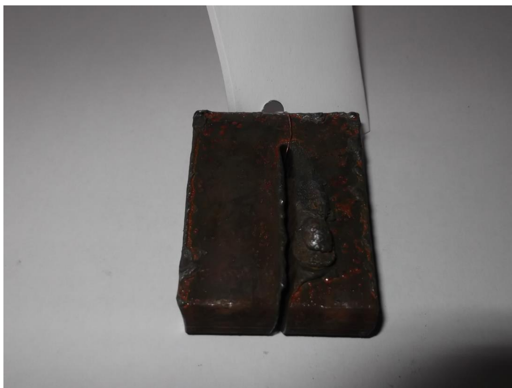
Слика 117 – Узорак 20 - диза I нивоа похабаности - 425 mm/min
