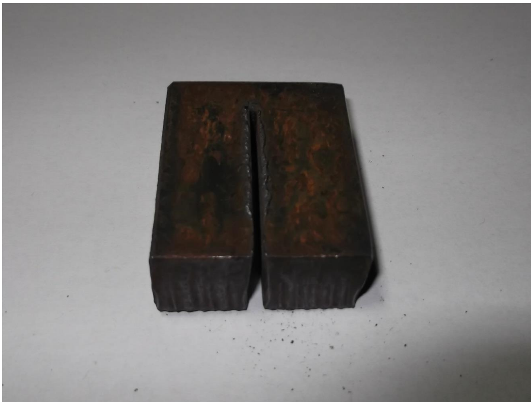
Слика 100 - Узорак 8 – 100A – 695 mm/min
