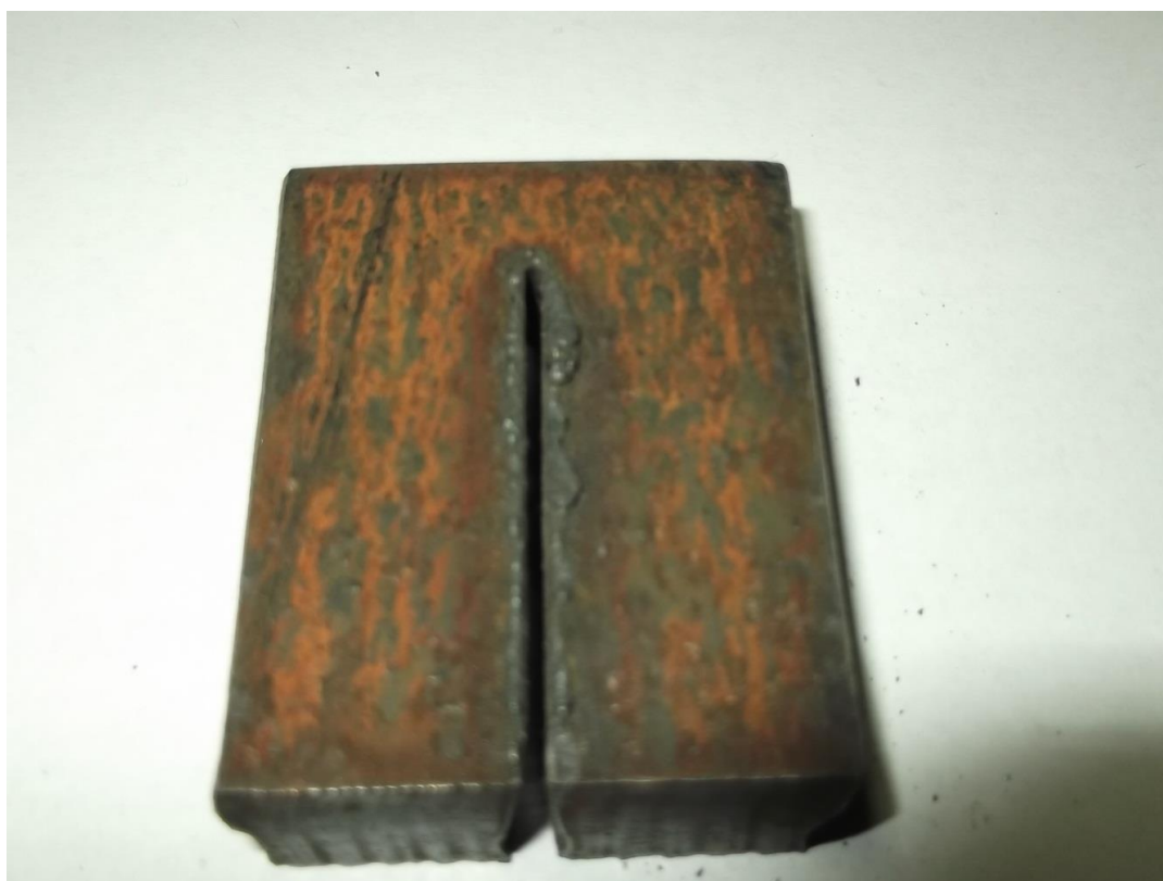
Слика 96 - Узорак 4 – 80A – 610 mm/min
