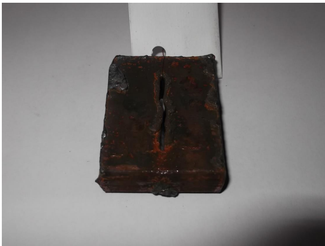
Слика 124 – Узорак – 27 диза III нивоа похабаности - 635 mm/min
