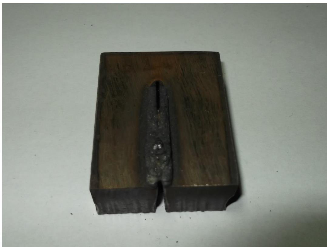
Слика 94 – Узорак 2 – 60A – 425 mm/min
