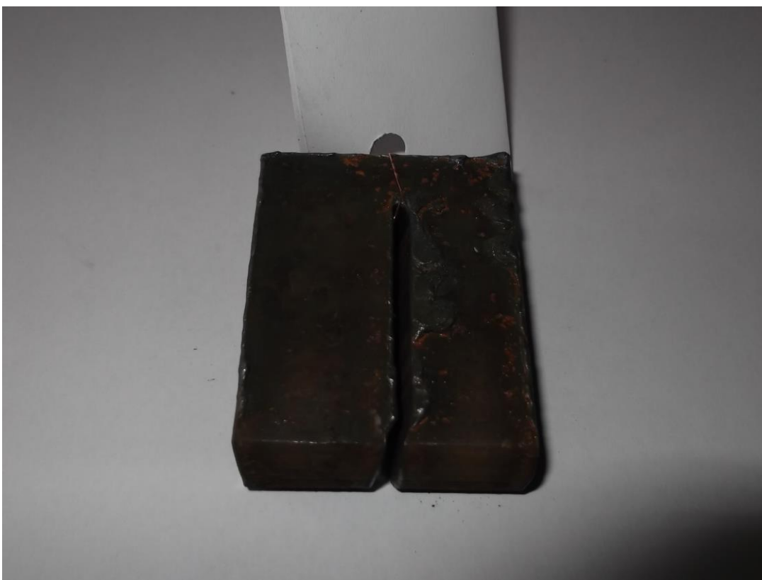
Слика 116 – Узорак 19 - диза I нивоа похабаности - 530 mm/min
