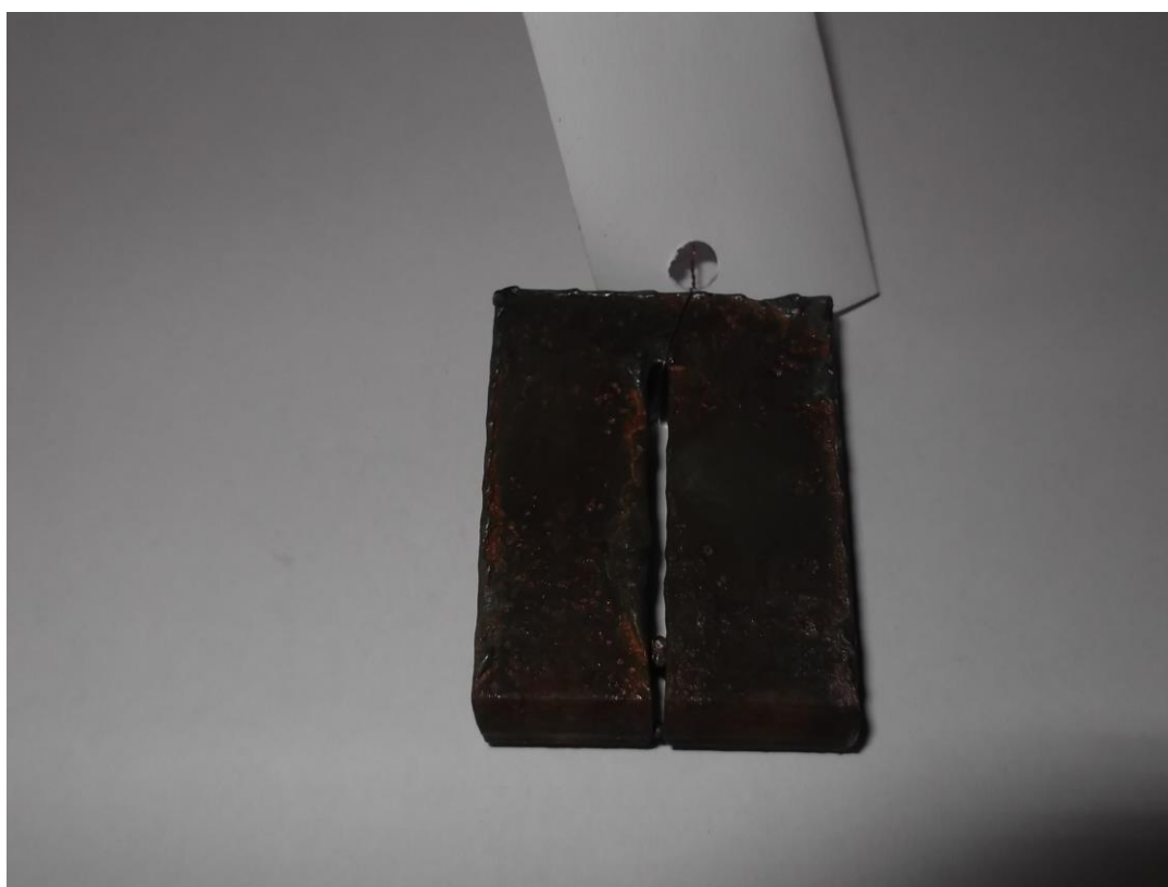
Слика 108 – Узорак 14 – 5,28 mm – 425 mm/min
