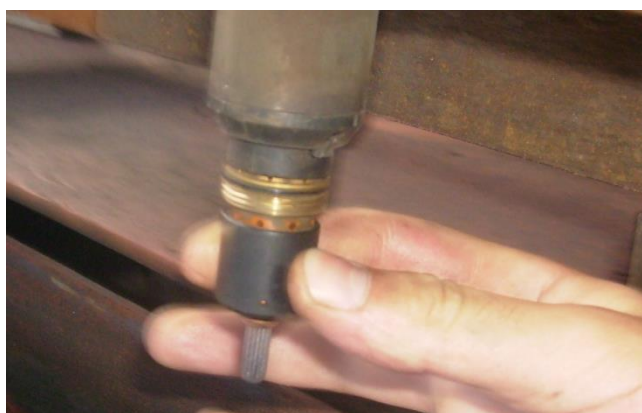
Слика 54– Скидање пластичне заштитне капе електроде
