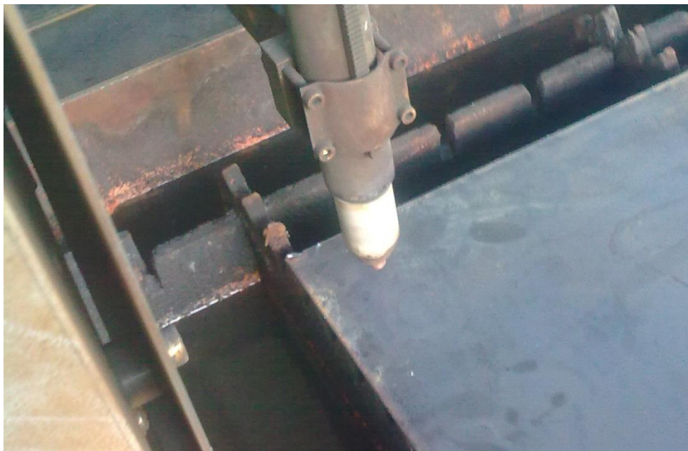
Слика 71– Бренер у тачки координатног почетка
