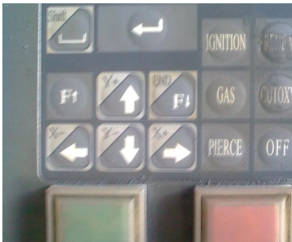
Слика 70– Тастатура за позиционирање
