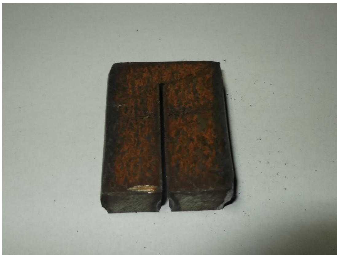
Слика 104 - Узорак 12 – 120A – 1585 mm/min
