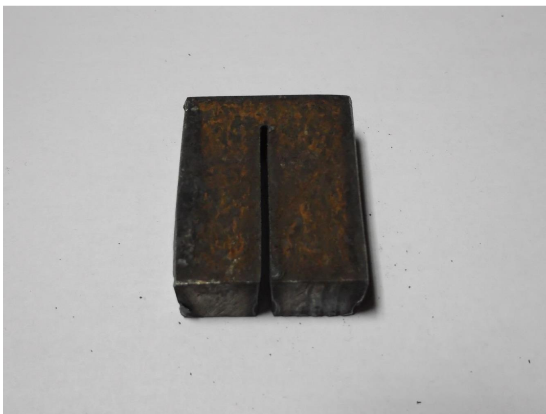
Слика 103 - Узорак 11 – 120A – 1055 mm/min
