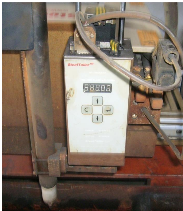
Слика 24 – ТХЦ и бренер за сечење
