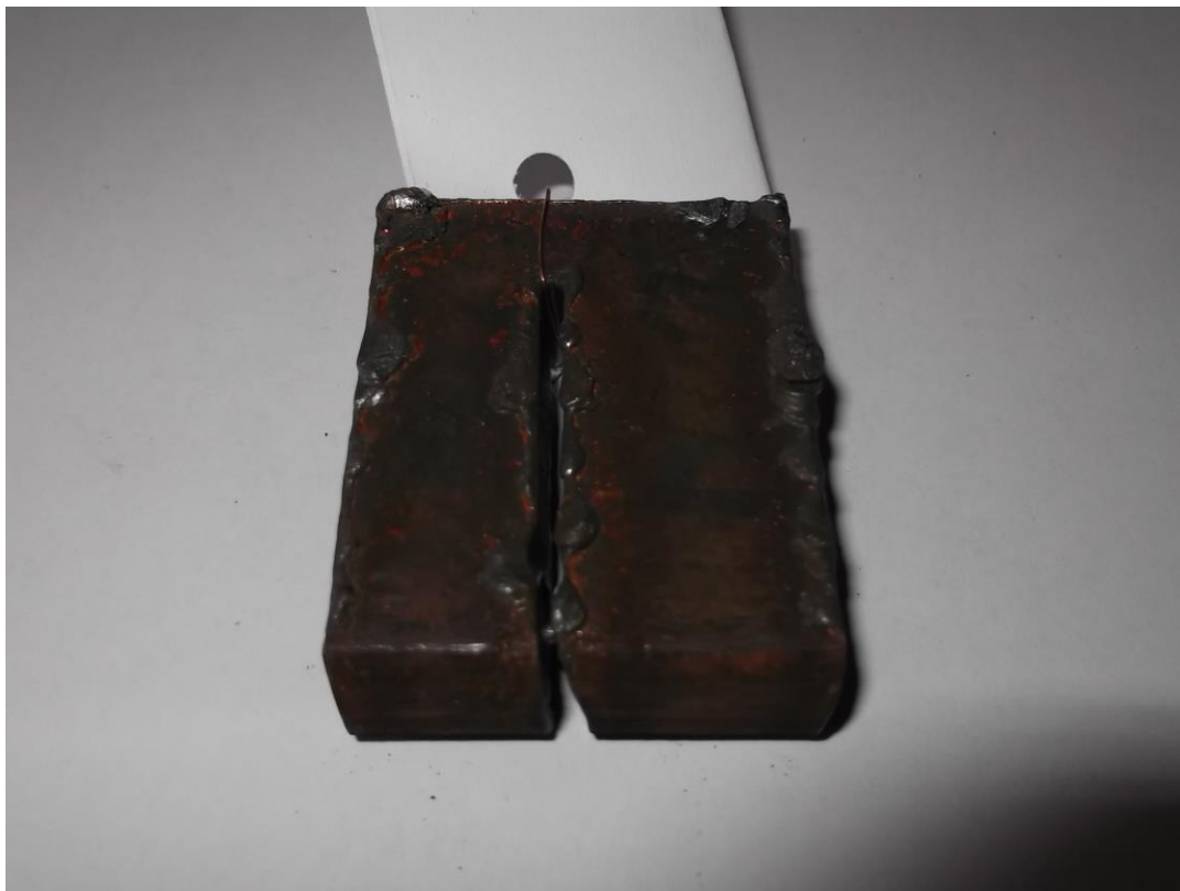
Слика 120 – Узорак – 23 дизна II нивоа похабаности - 425 mm/min
