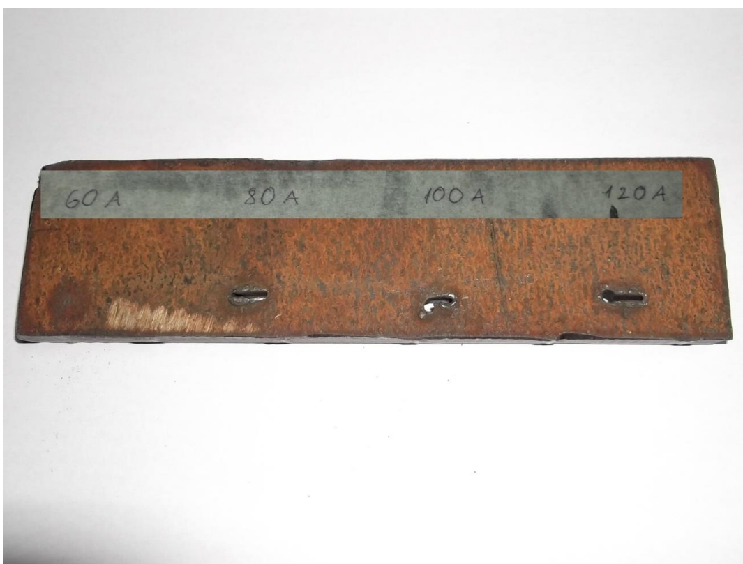
Слика 92 – Пробијање различитим јачинама струје
