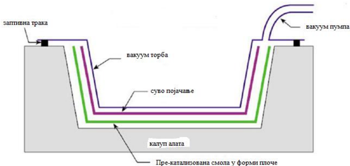
Слика 37. Приказ поступака инфузије слоја смоле [14]
