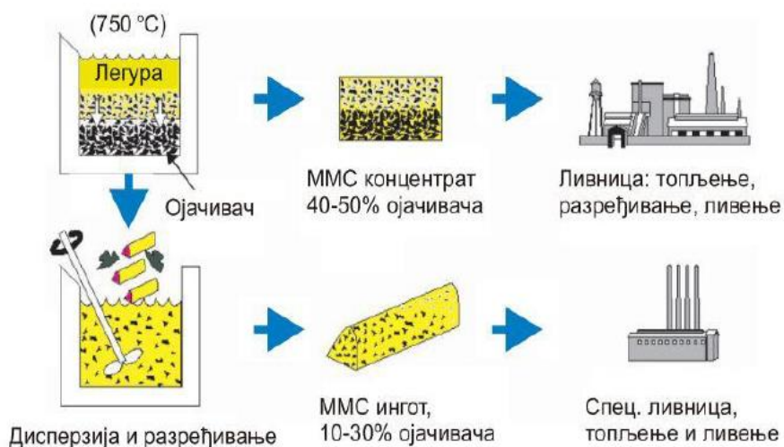
Слика 27. Шема производње ММЦ-а Primex инфилтрацијом [14]
