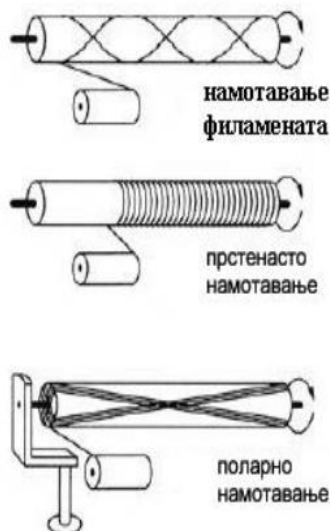
Слика 30. Приказ намотавања филамената, прстенастог и поларног намотавања
