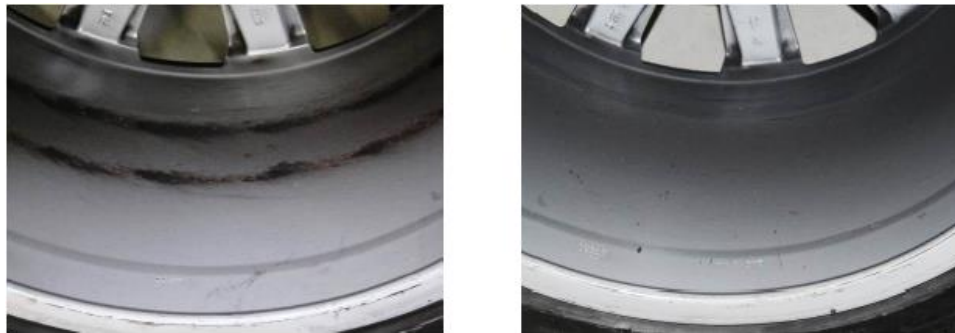
Слика 13. Наплатак лево је са обрађеним диском а наплатак десно је са стандардним диском [4]
