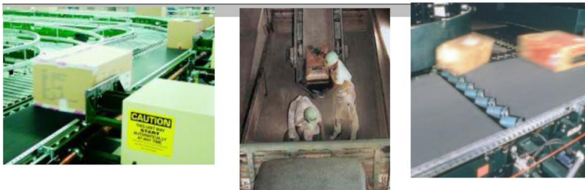
Слика 3.58 Истовар комадних терета: а) бочним потискивачем, б) мануелно, в) батеријом ваљака [5]
