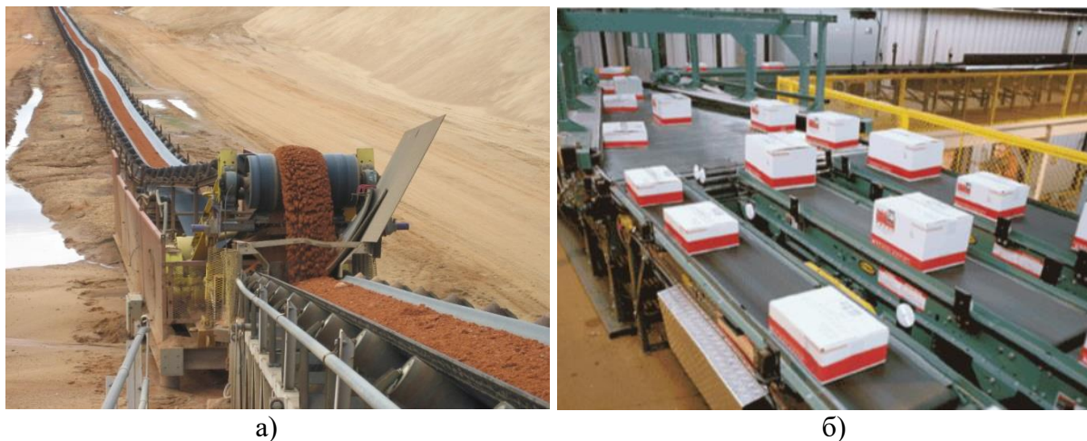
Слика 2.1 Тракасти транспортер за: а) транспорт насипних и б) комадних материјала [4,5]
