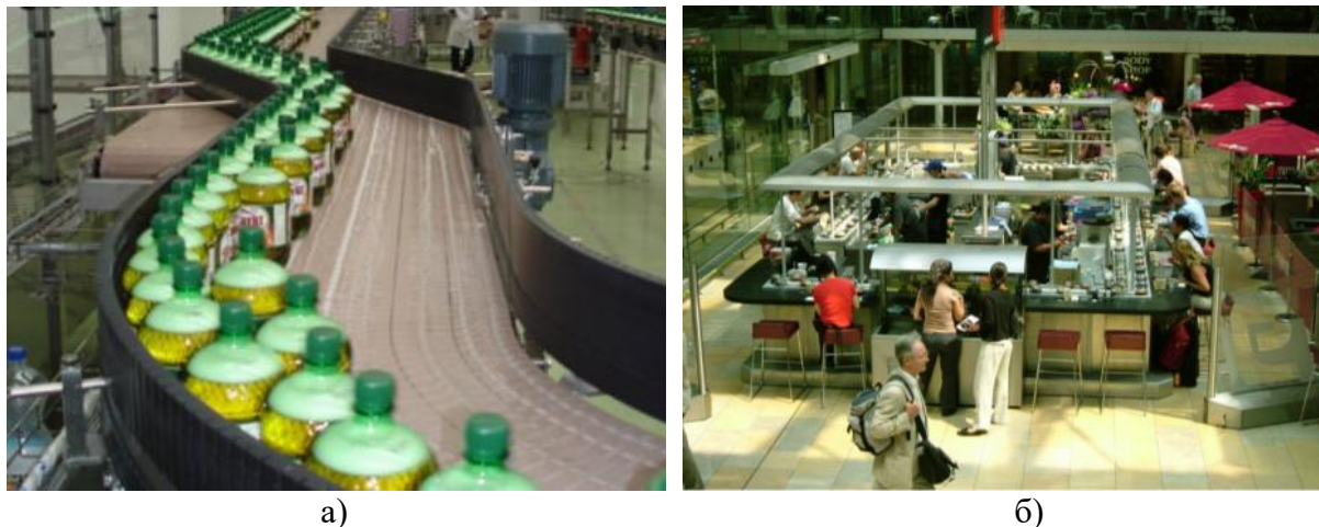
Слика 2.2 Тракасти транспортер у: а) фабрици за пуњење боца и б) суши ресторану са транспортном траком „Yo! Sushi“ у лондонској подземној железничкој станици Paddington [1]
