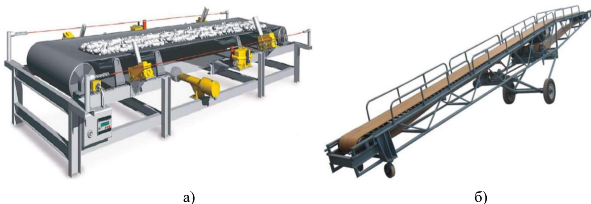
Слика 2.3 Тракасти транспортер за транспорт материјала: а) хоризонтално и б) под углом [6]
