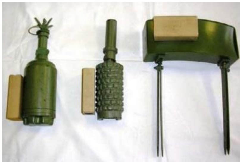
Слика 11 – Позиције постављања експлозивног пуњења на противпешадијске распрскавајуће мине: PROM-1, PMR-2AS, MRUD [7]
