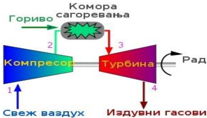
Слика 3.2. Шема гасне турбине
