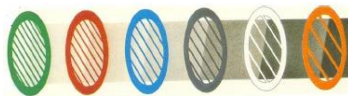
Слика 4.22 Филтери различитог меш броја (100, 80, 50, 40, 30, 20)
