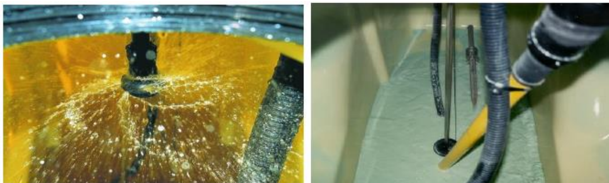
Слика 4.18 Испирање резервоара помоћу ротационих распрскивача
