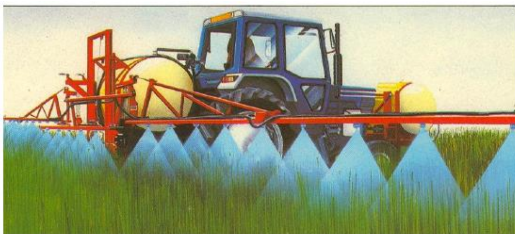
Слика 4.48 Расподела пестицидне течности по површини третирања
