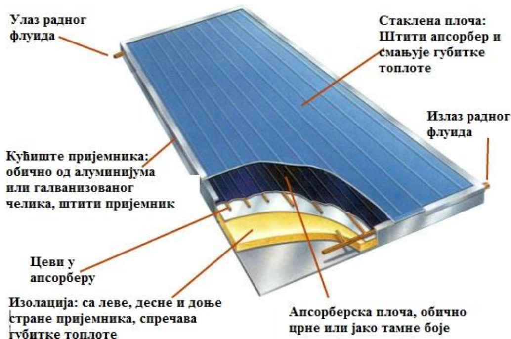
Слика 11. Раван водени пријемник сунчевог зрачења [7]
