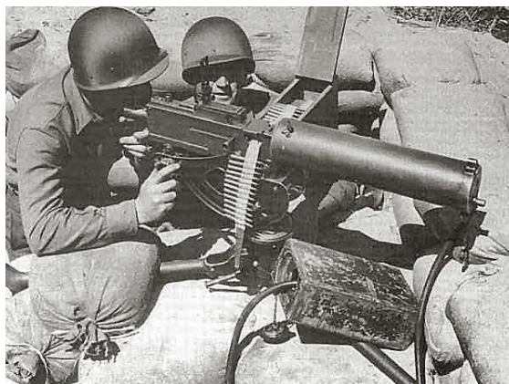
Слика 2.7. Хлађење цеву митраљеза Browning M1917
