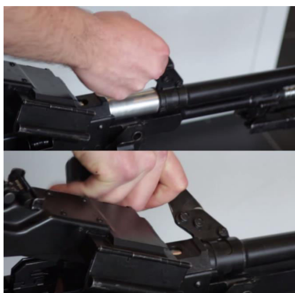
Слика 2.3. Замена загрејане цеви са хладном цеви
