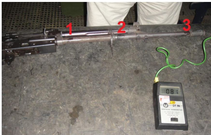
Слика 4.1. Мерење температуре спољне трасе цеви на местима 1, 2 и 3
