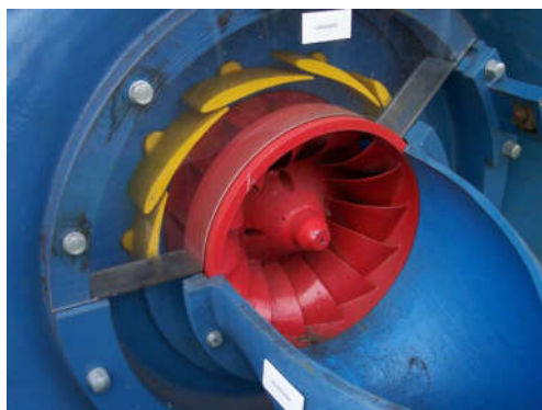
Слика 2.5. Усмеравајуће лопатице при минималном протоку воде
