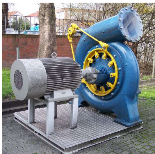
Слика 2.9. Францисова турбина спојена са генератором
