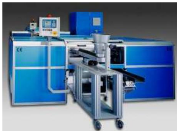
Слика 32. Ролне за сецање за континуирану производњу сировина [2]
