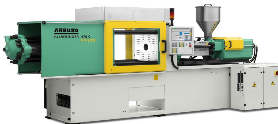
Слика 38. Машина за бризгање ALLROUNDER 470 C GOLDEN EDITION [14]
