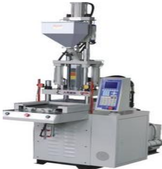
Слика 36. Вертикална машина за бризгање [12]
