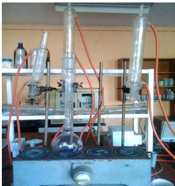
Слика 47. Уређај за одмашћивање узорака
