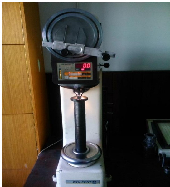
Слика 46. Уређај за испитивање тврдоће
