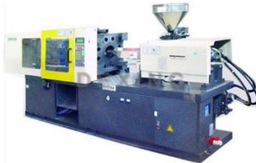
Слика 34. DXCJ120M3V Машина за бризгање [10]
