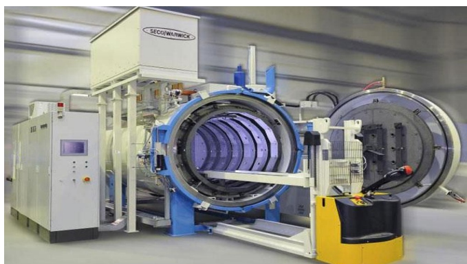
Слика Стандардна вакуумска пећ за синтеровање [17]
