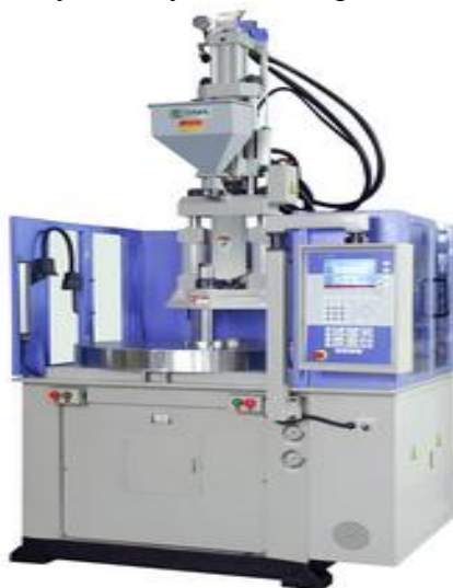
Слика 35. TY-350.2R.SF Вертикална машина за бризгање [11]
