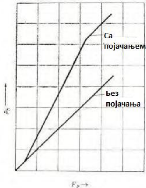
Слика 13 - Карактеристика једног серво појачивача у функцији притиска кочног флуида ( p_k ) и силе на педали кочнице ( F_p ), [2]
