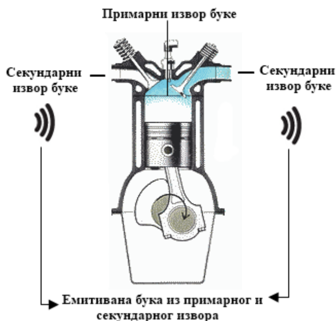
Слика 3.11. Примарни и секундарни извори буке усисавања и издишавања мотор сус
