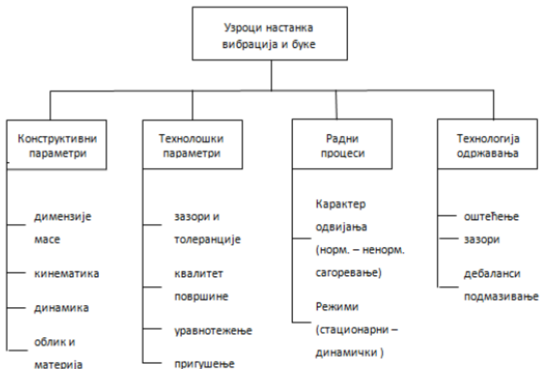
Слика 3.1. Основни узроци појава вибрација и буке [1]
