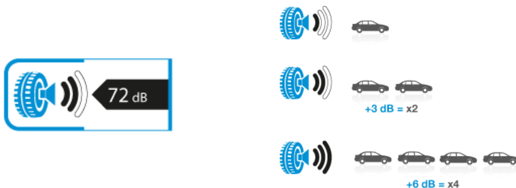
Слика 3.4. Спољашња бука пнеуматика у dB [7]
