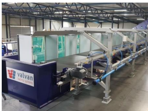
Слика 52. FiberSort технологија сортирања текстила [114]
