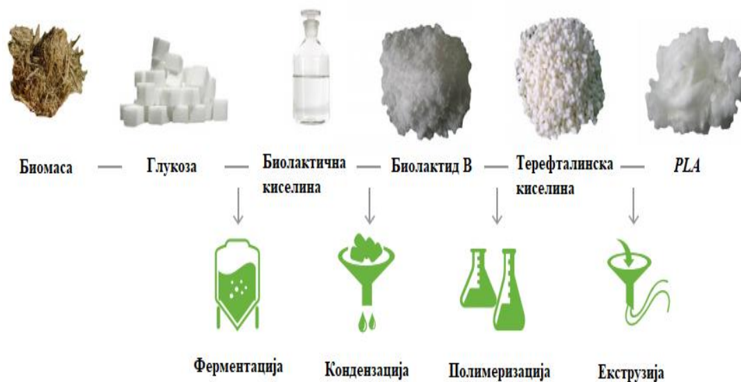
Слика 61. Производни процес PLA [137]
