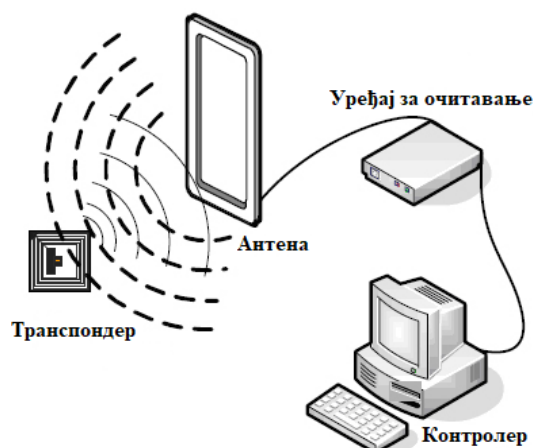
Слика 53. Шема RFID система [119]
