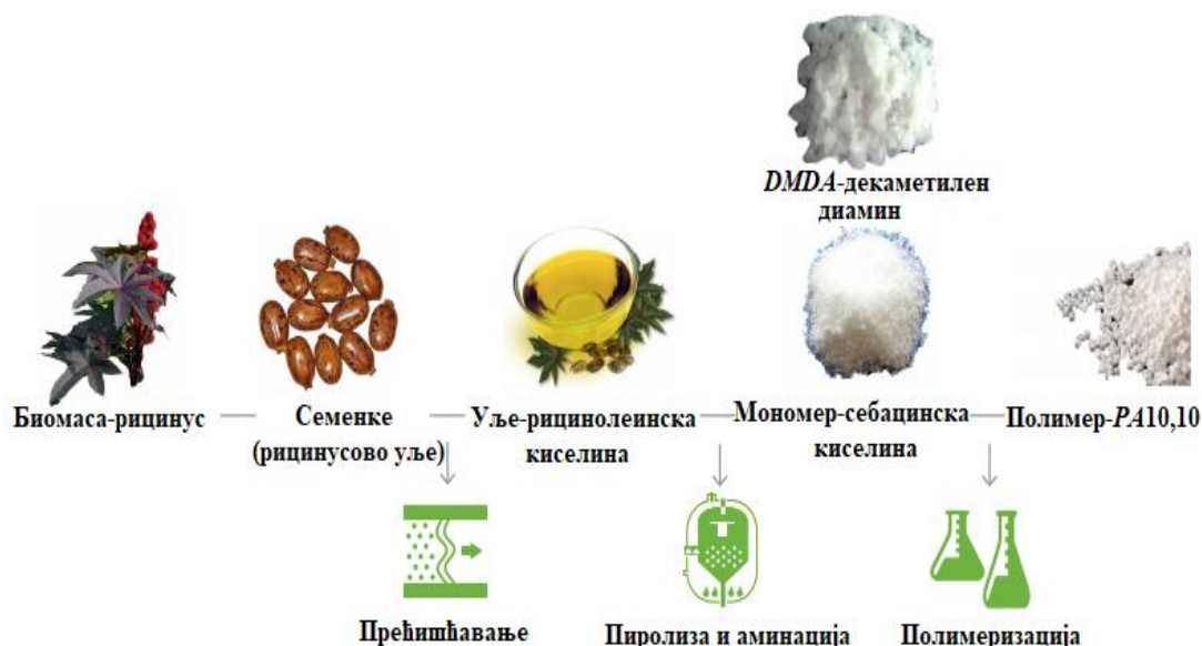
Слика 62. Производни процес биолошког полиамида [137]
