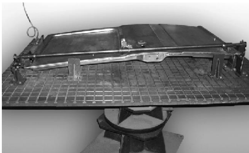
Слика 4.7 Елементи склопа врата камиона
