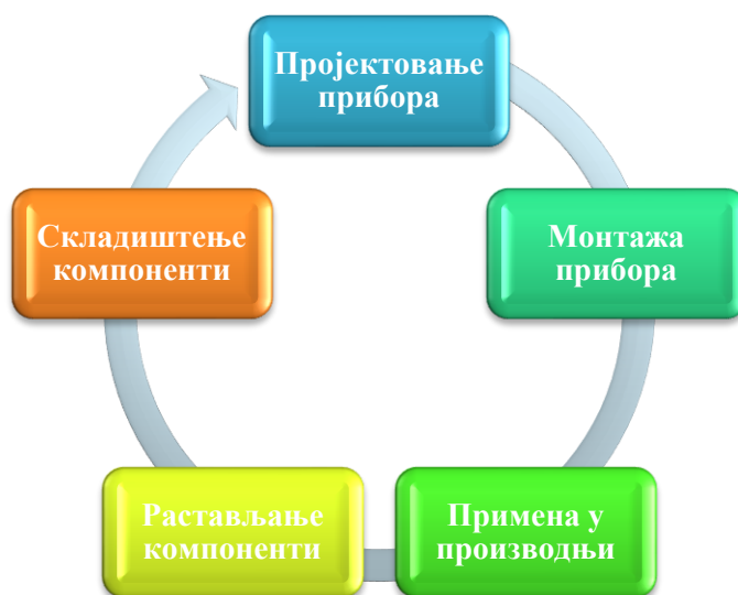
Слика 2.1 Концепт примене модуларног стезног прибора
