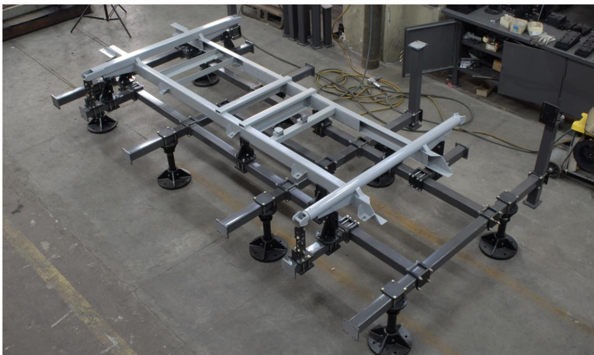
Слика 4.9 Пример примене флексибилног стезног прибора за предмете обраде великих димензија
