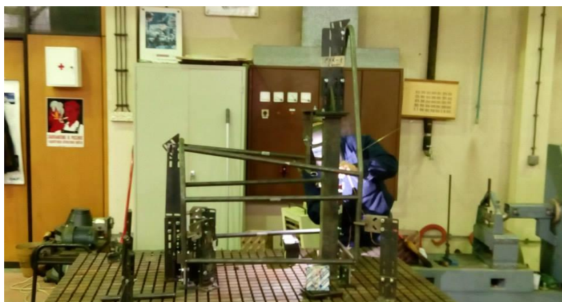
Слика 7.26 Заваривање дела рама
