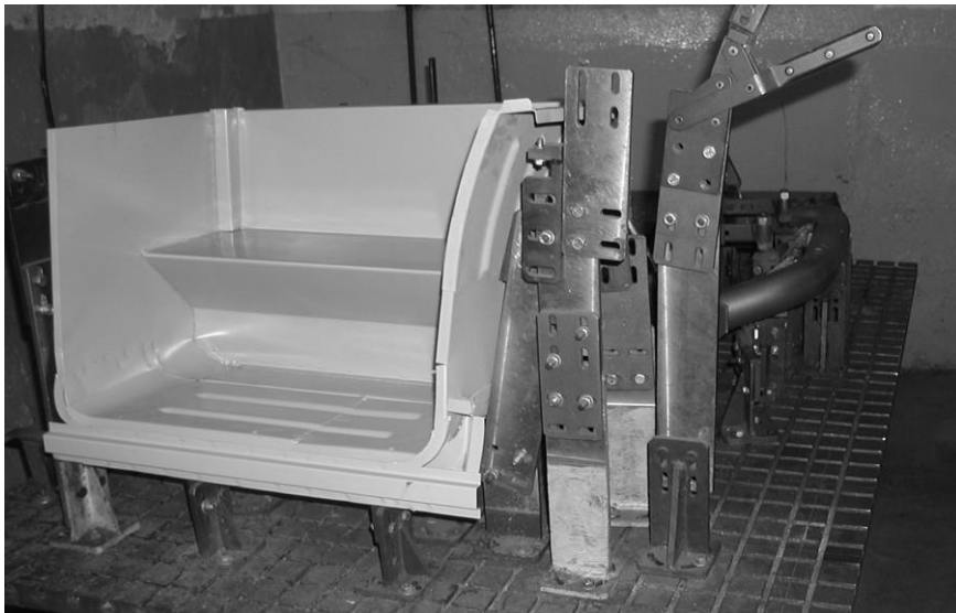
Слика 4.4 Елементи склопа степеница кабине камиона
