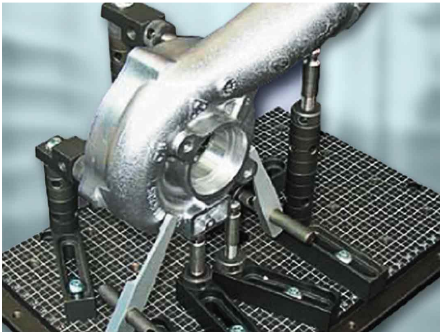
Слика 3.8 Примена флексибилног стезног прибора при машинској обради у ауто индустрији
